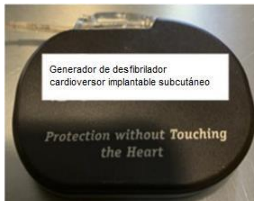
Figura 21. Desfibrilador cardíaco subcutáneo implantable.
