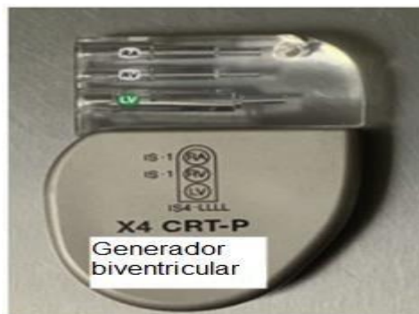
Figura 22. Generador de un marcapasos con terapia de resincronización cardíaca.
