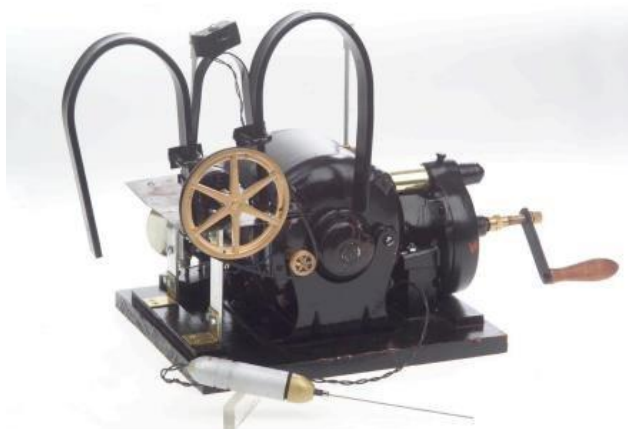
Figura 1. Dispositivo de Hyman. Generador accionable a manivela.
