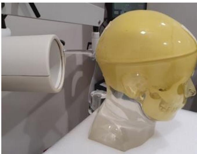
*Nota.* Geometría de medición de cabeza utilizada para la calibración de la sonda de captación Captus 4000 del Laboratorio Ciclotrón - PET/CT para mediciones *in vivo* de  $^{18}\text{F}$ -FDG. Foto tomada por Alexander Bonilla Araya.
