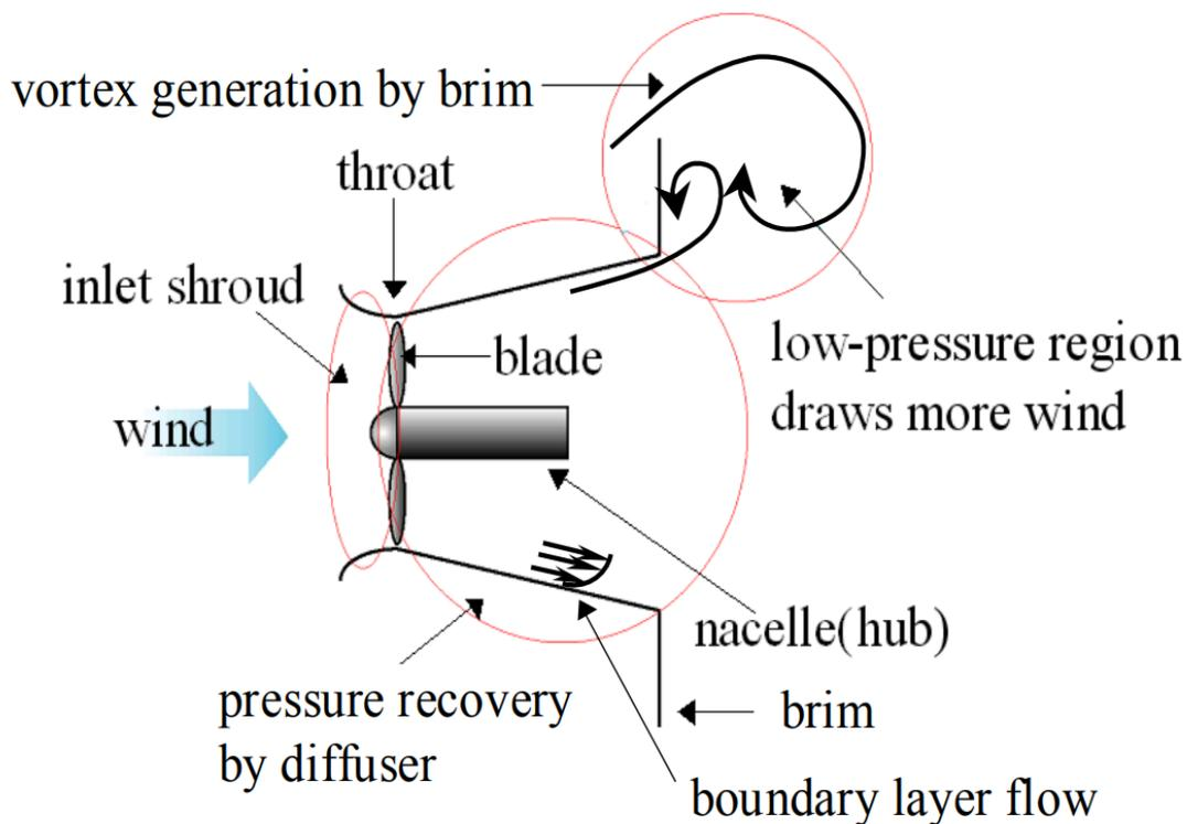
Figura 4.13: Flujo alrededor de una turbina equipada con un Wind Lens [2].
