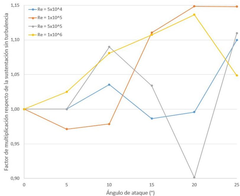
Figura 3.18: Variación del  $C_L$  del perfil NACA0012 para  $IT = 30\%$  respecto de  $IT = 0\%$ .
