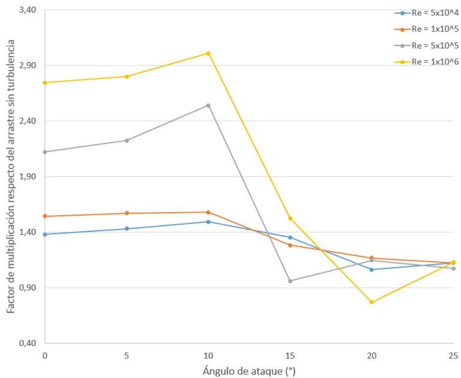
Figura 3.22: Variación del  $C_D$  del perfil S809 para  $IT = 30\%$  respecto de  $IT = 0\%$ .
