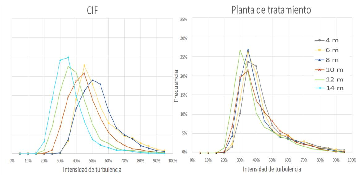
Figura 2.9: Histogramas de la intensidad de turbulencia en ambas torres de medición en el mes de julio de 2019, CIF a la izquierda y Planta a la derecha.
