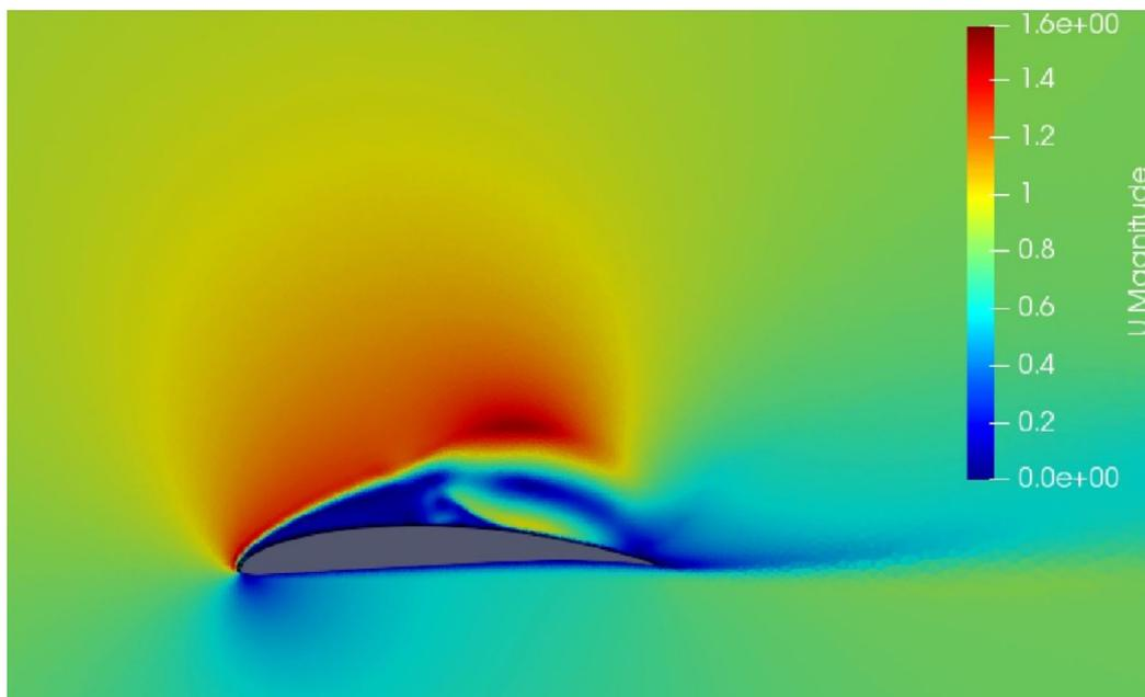
Figura 3.12: Campo de velocidad en el perfil SG6043 con el modelo  $k - \omega$  SST.
