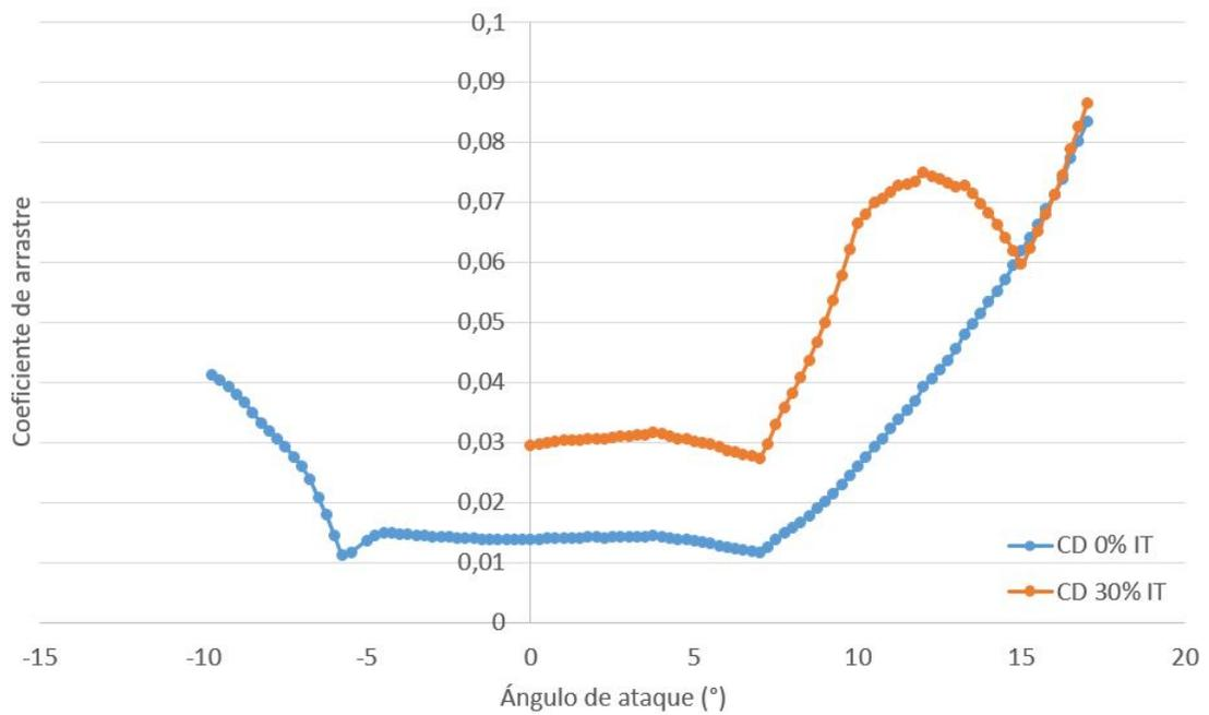
Figura C.12: Coeficiente de arrastre del perfil S809 para  $Re = 5 \times 10^5$ .
