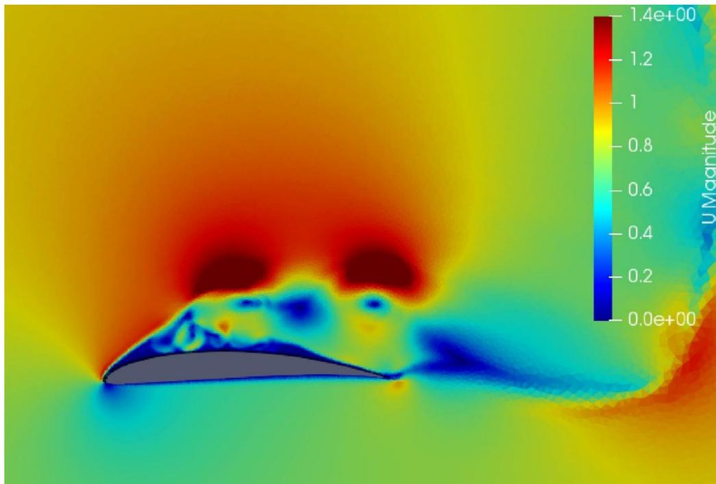
Figura 3.13: Campo de velocidad en el perfil SG6043 con el modelo  $\gamma - Re_\theta$ .
