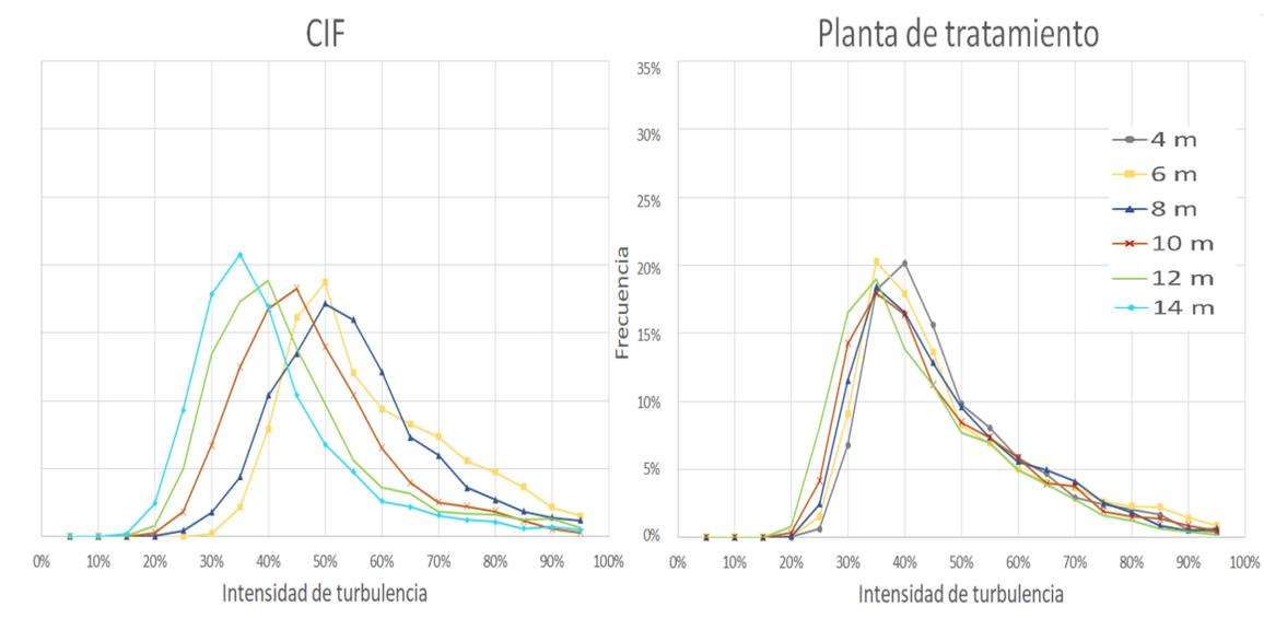
Figura 2.10: Histogramas de la intensidad de turbulencia en ambas torres de medición en el mes de septiembre de 2019, CIF a la izquierda y Planta a la derecha.
