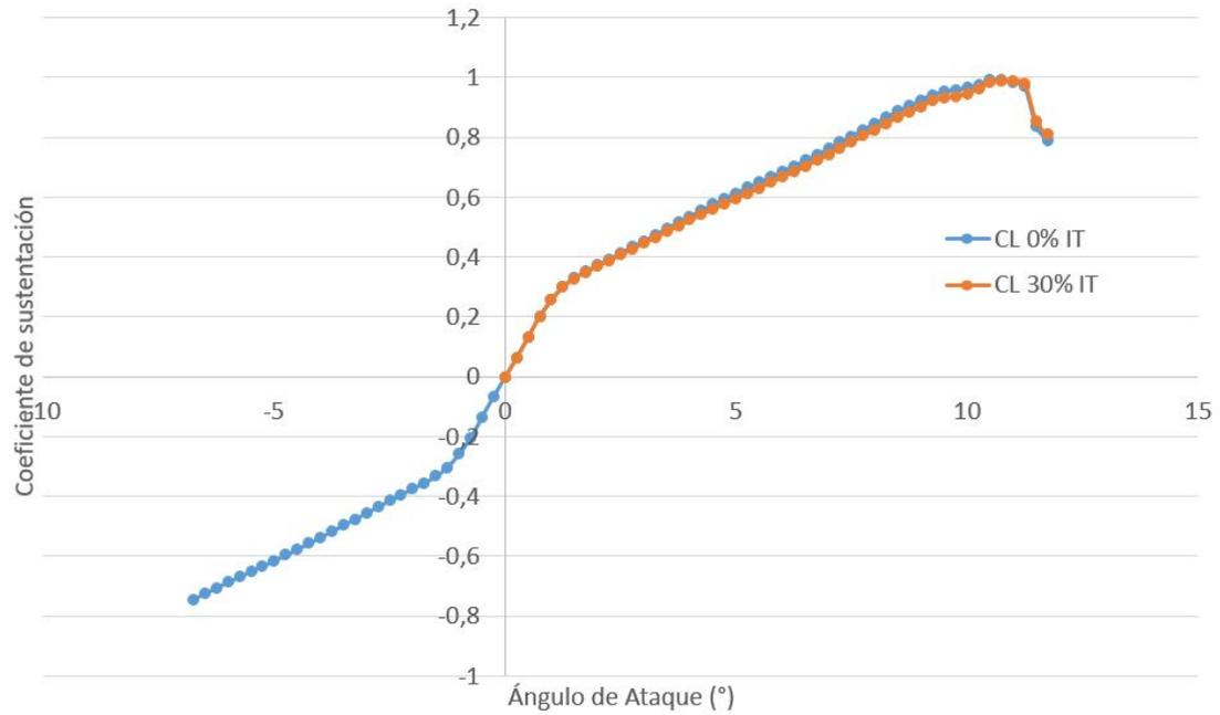
Figura C.5: Coeficiente de sustentación del perfil NACA0012 para  $Re = 10^5$ .
