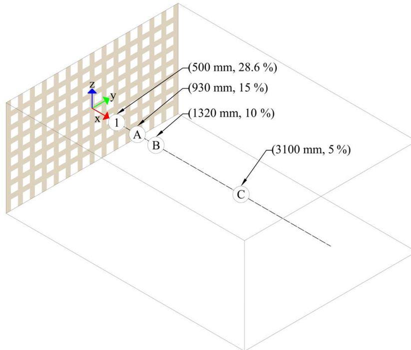
Figura 4.7: Estaciones de medición del efecto del WL en el flujo turbulento.
