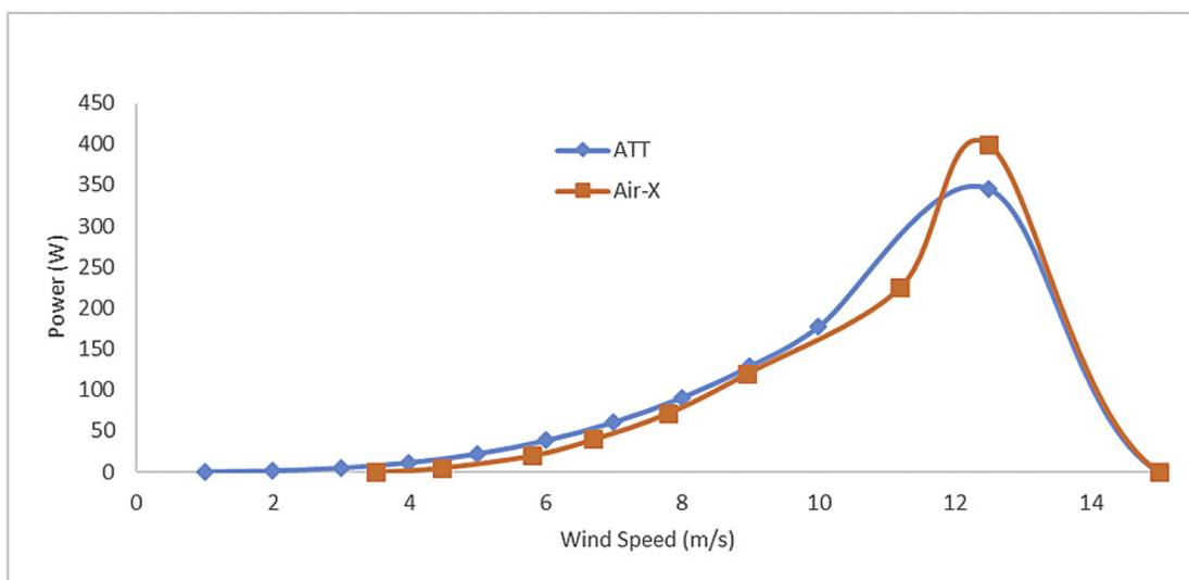
Figura 3.25: Curva de potencia de la turbina ATT [1].
