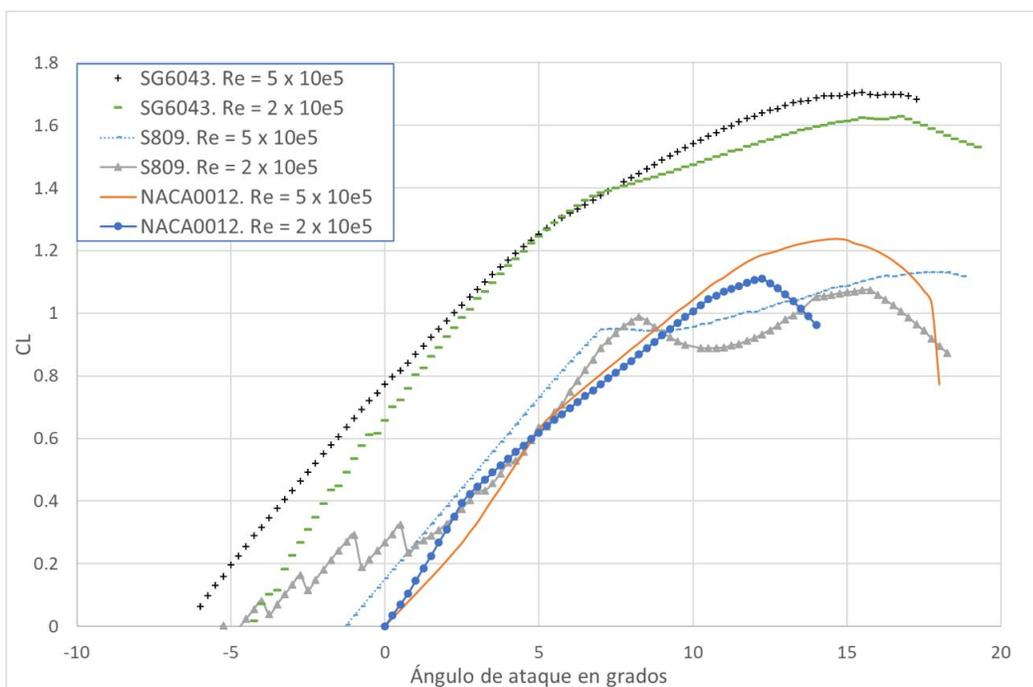
Figura 3.3: Coeficiente de sustentación para los perfiles SG6043, S809 y NACA0012.
