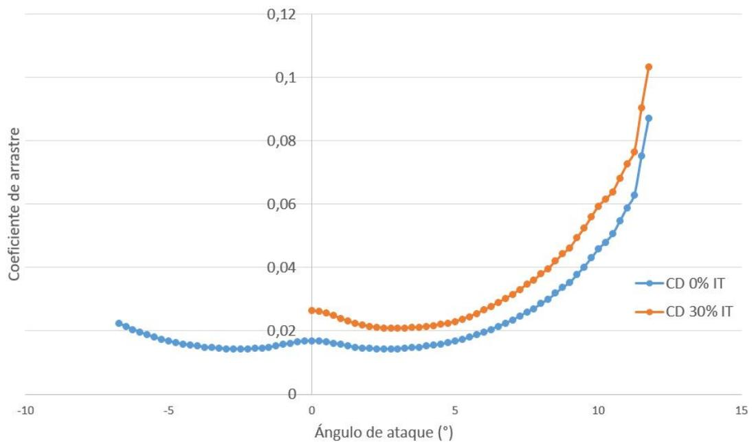
Figura C.6: Coeficiente de arrastre del perfil NACA0012 para  $Re = 10^5$ .
