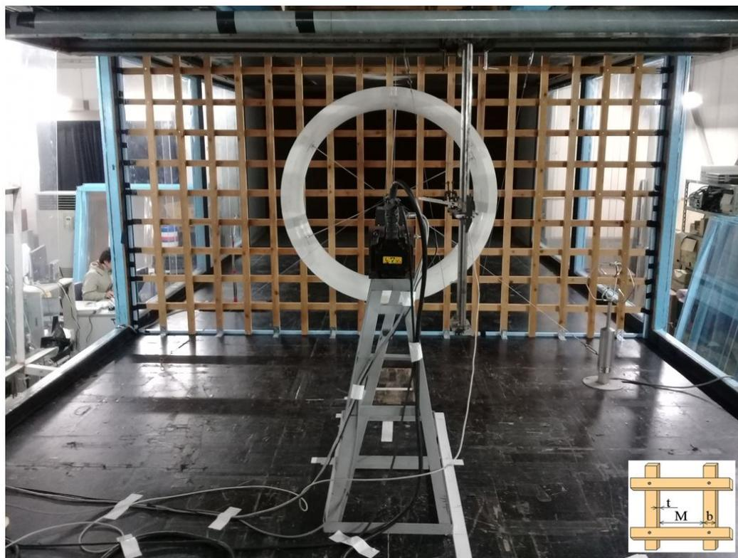
Figura 4.2: Rejilla para generación de turbulencia.
