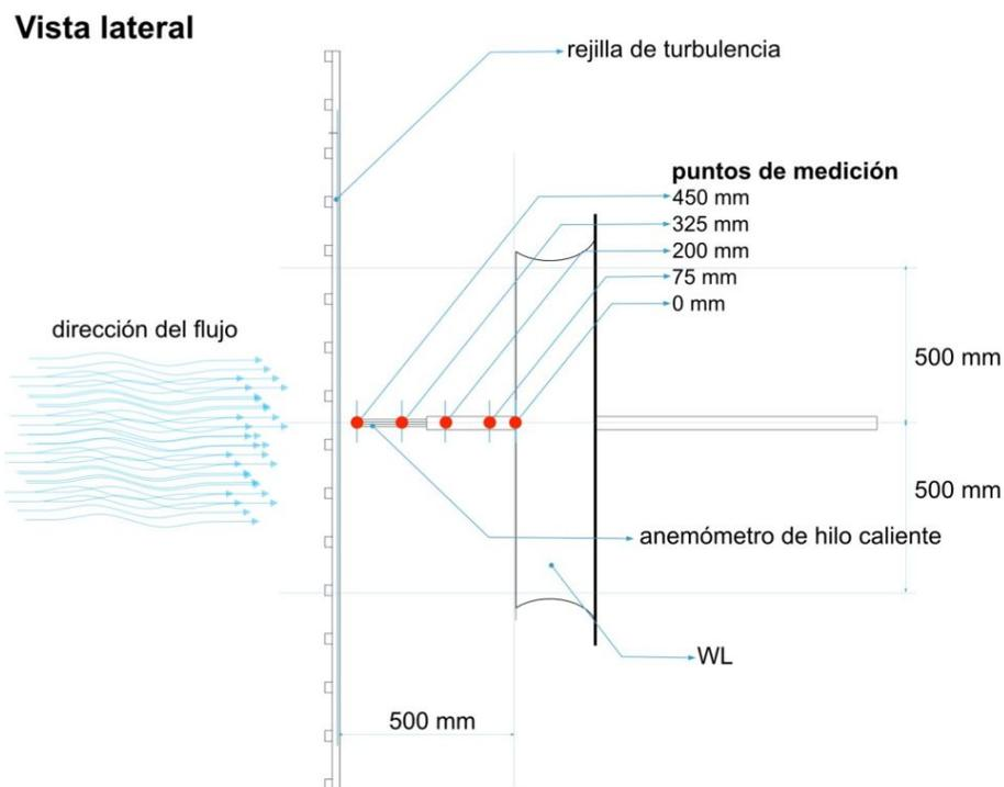
Figura 4.9: Puntos de medición del efecto del WL en el flujo turbulento, estación 1.
