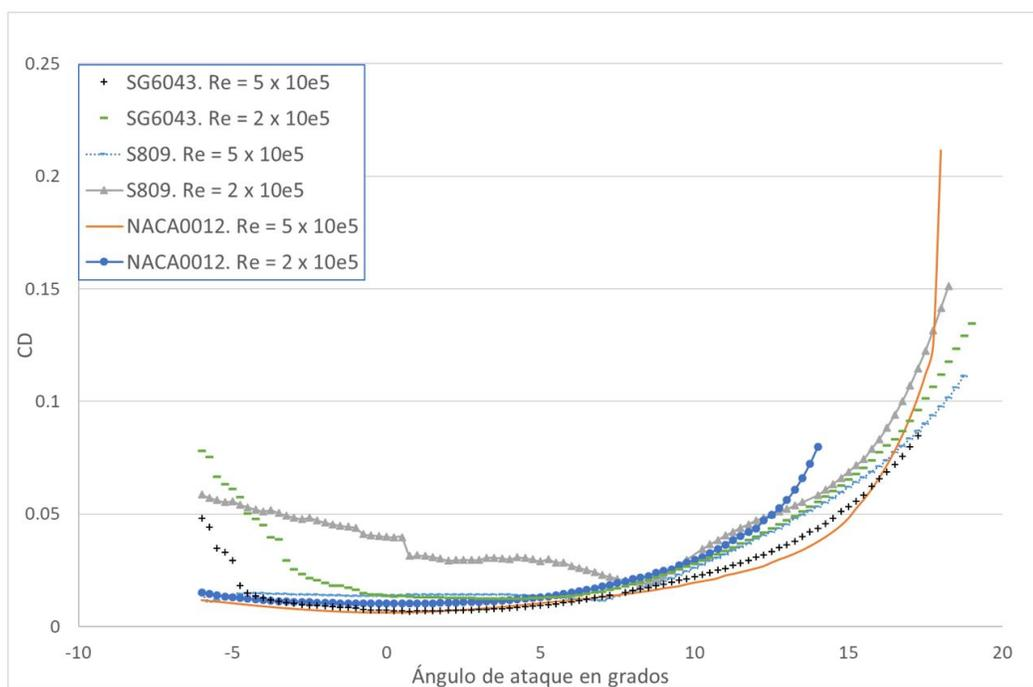
Figura 3.2: Coeficiente de arrastre para los perfiles SG6043, S809 y NACA0012.
