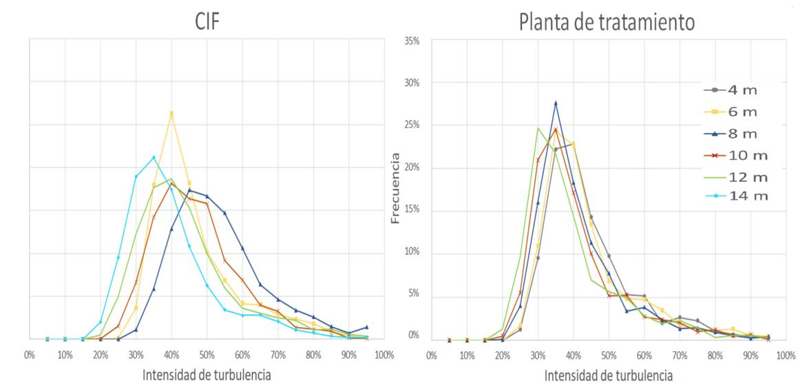
Figura 2.5: Histogramas de la intensidad de turbulencia en ambas torres de medición en el mes de noviembre de 2018, CIF a la izquierda y Planta a la derecha.
