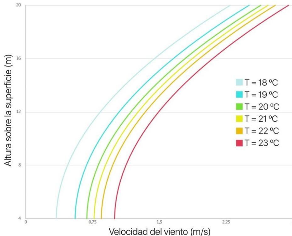
Figura 2.4: Velocidad del viento en función de la altura según el modelo propuesto en la sub capa rugosa, para varias temperaturas (indicadas en °C).
