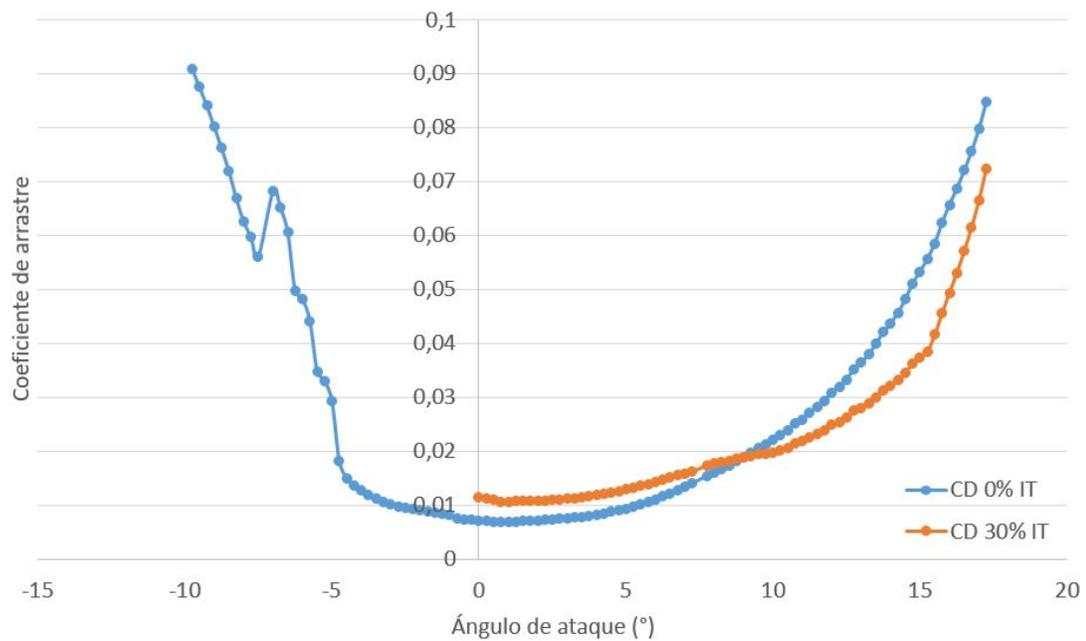
Figura C.4: Coeficiente de arrastre del perfil SG6043 para  $Re = 5 \times 10^5$ .
