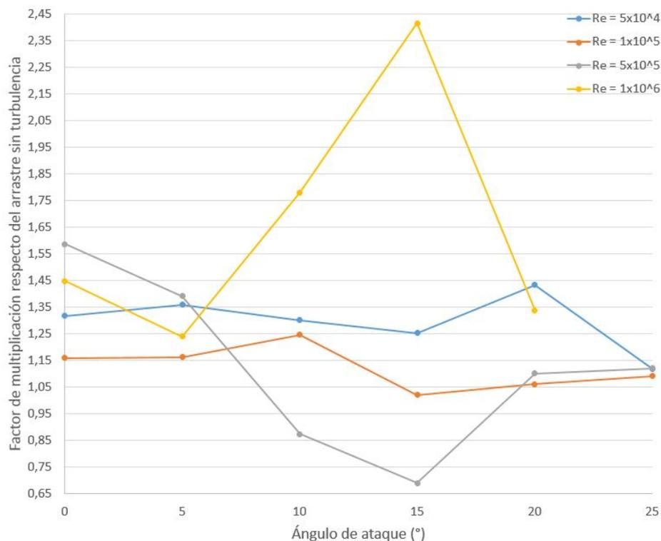
Figura 3.16: Variación del  $C_D$  del perfil SG6043 para  $IT = 30\%$  respecto de  $IT = 0\%$ .
