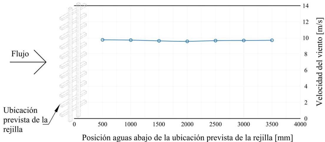
Figura 4.10: Velocidad del viento en el eje del túnel sin rejilla de turbulencia.
