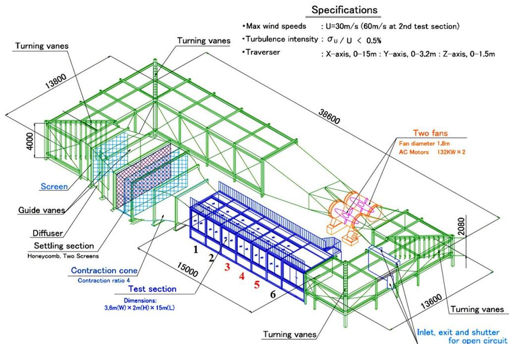
Figura 4.1: Túnel de viento de la Universidad de Kyushu.
