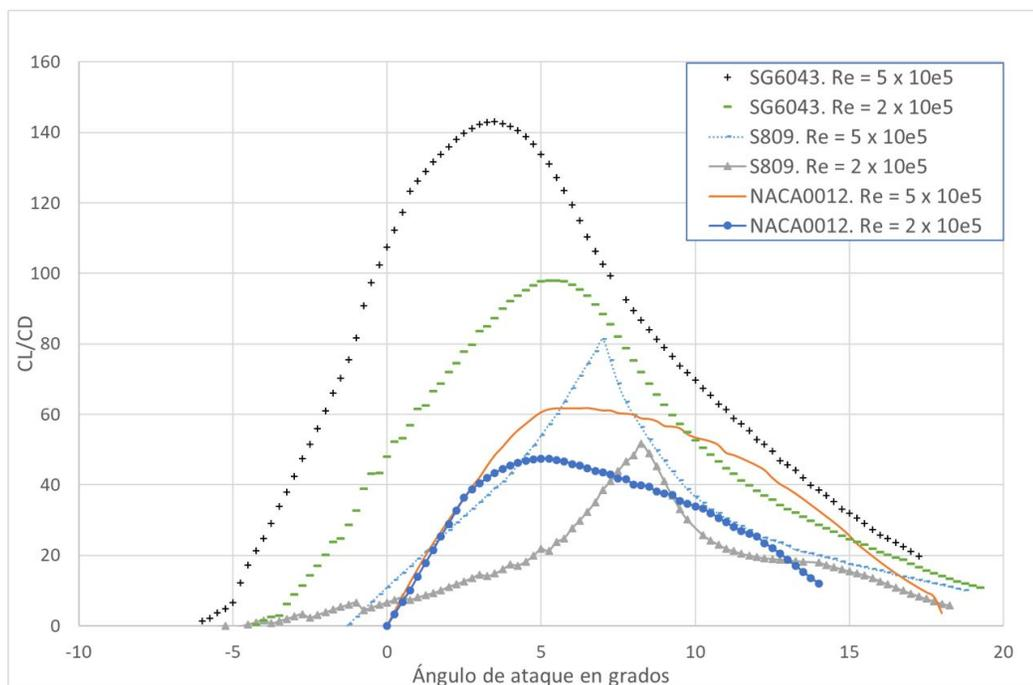
Figura 3.4:  $C_L/C_D$  para los perfiles SG6043, S809 y NACA0012 para números de Reynolds bajos.
