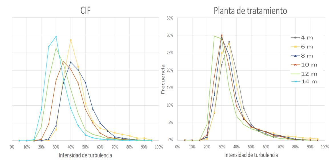
Figura 2.6: Histogramas de la intensidad de turbulencia en ambas torres de medición en el mes de enero de 2019, CIF a la izquierda y Planta a la derecha.
