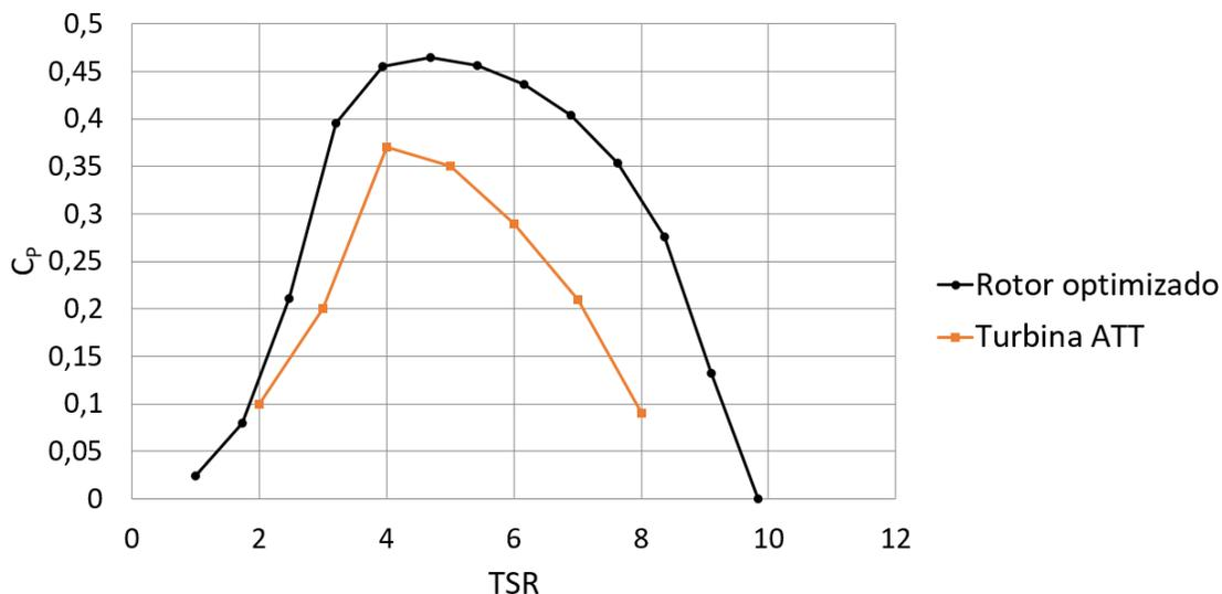
Figura 3.26: Coeficiente de potencia del rotor diseñado y de la turbina ATT.
