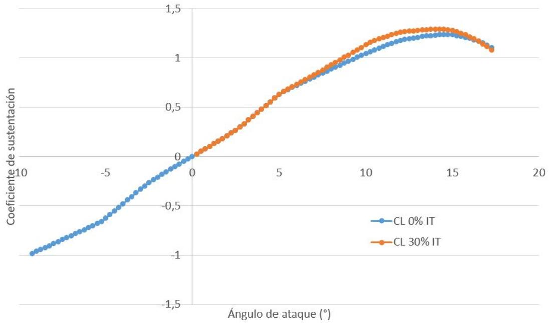
Figura C.7: Coeficiente de sustentación del perfil NACA0012 para  $Re = 5 \times 10^5$ .
