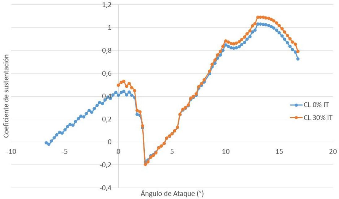
Figura C.11: Coeficiente de sustentación del perfil S809 para  $Re = 5 \times 10^5$ .
