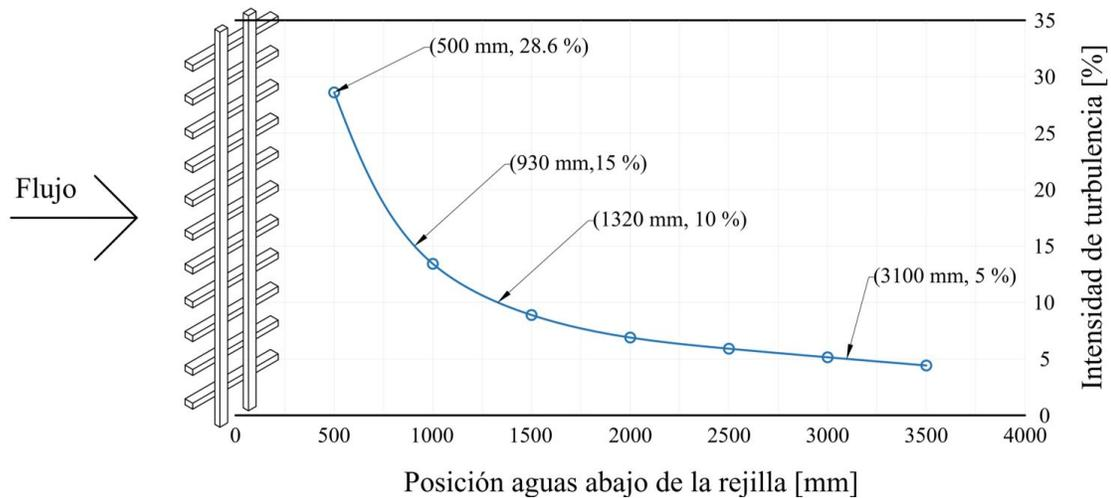
Figura 4.11: Intensidad de turbulencia en el eje del túnel con rejilla de turbulencia.
