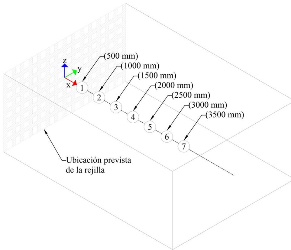
Figura 4.6: Estaciones de medición de la velocidad en el eje del túnel.
