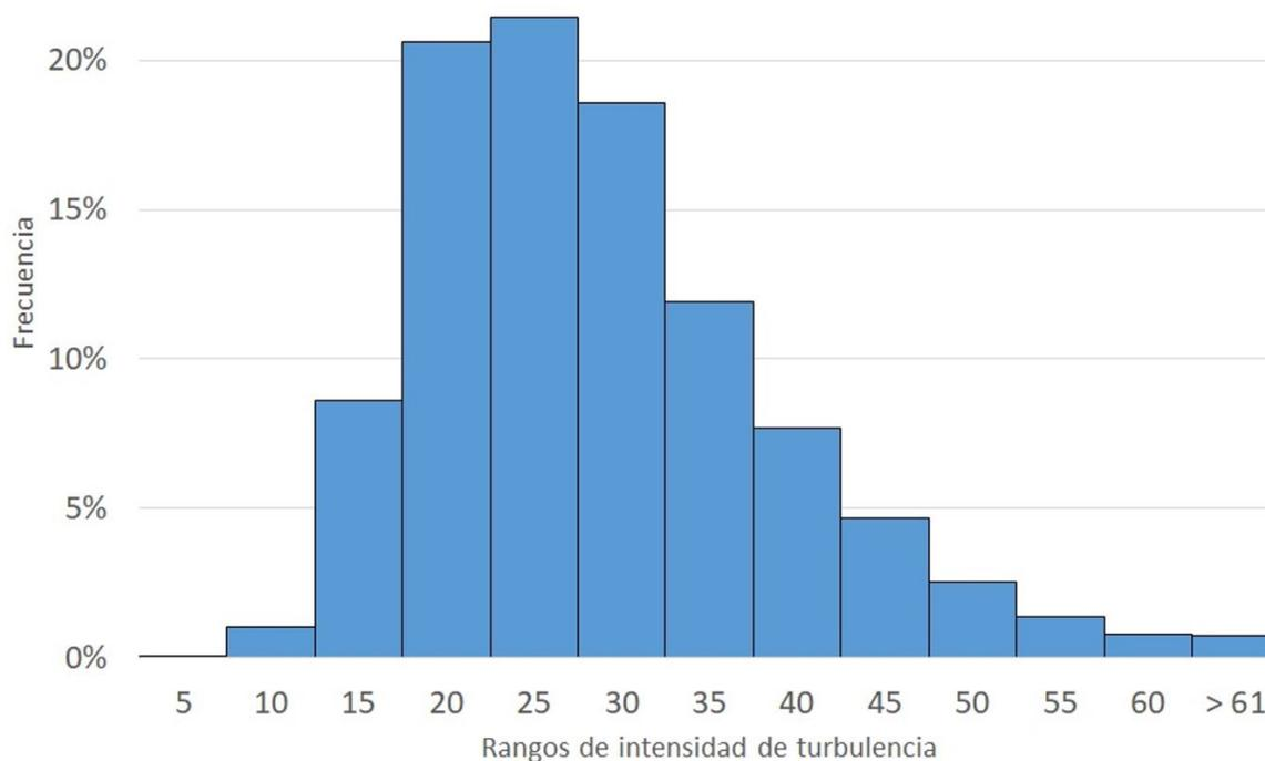
Figura 1.15: Histograma de la intensidad de turbulencia en la estación CIVCO.
