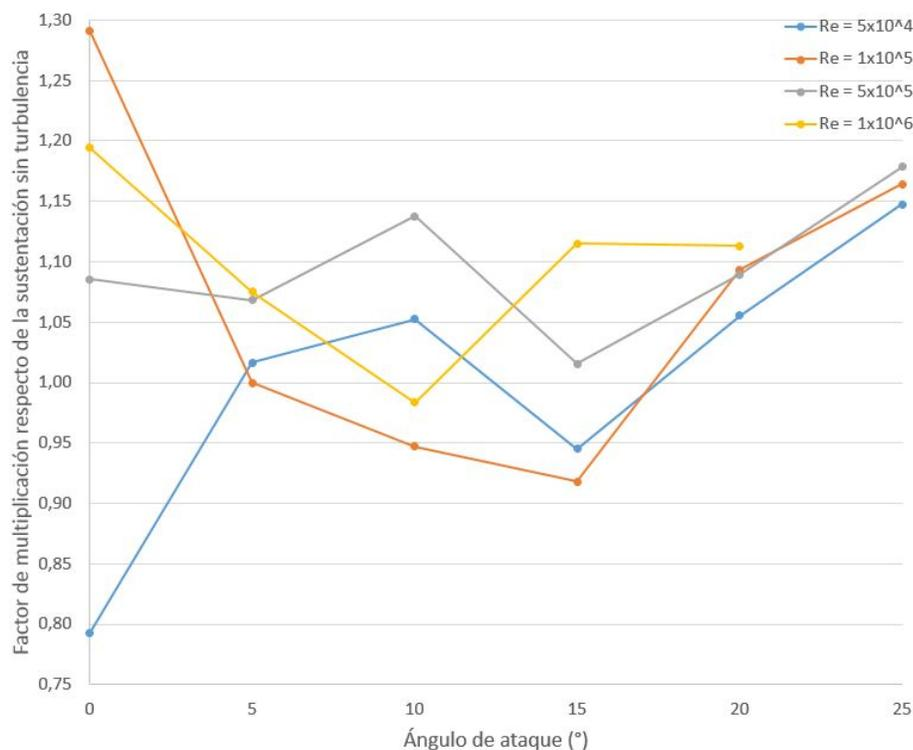
Figura 3.15: Variación del  $C_L$  del perfil SG6043 para  $IT = 30\%$  respecto de  $IT = 0\%$ .
