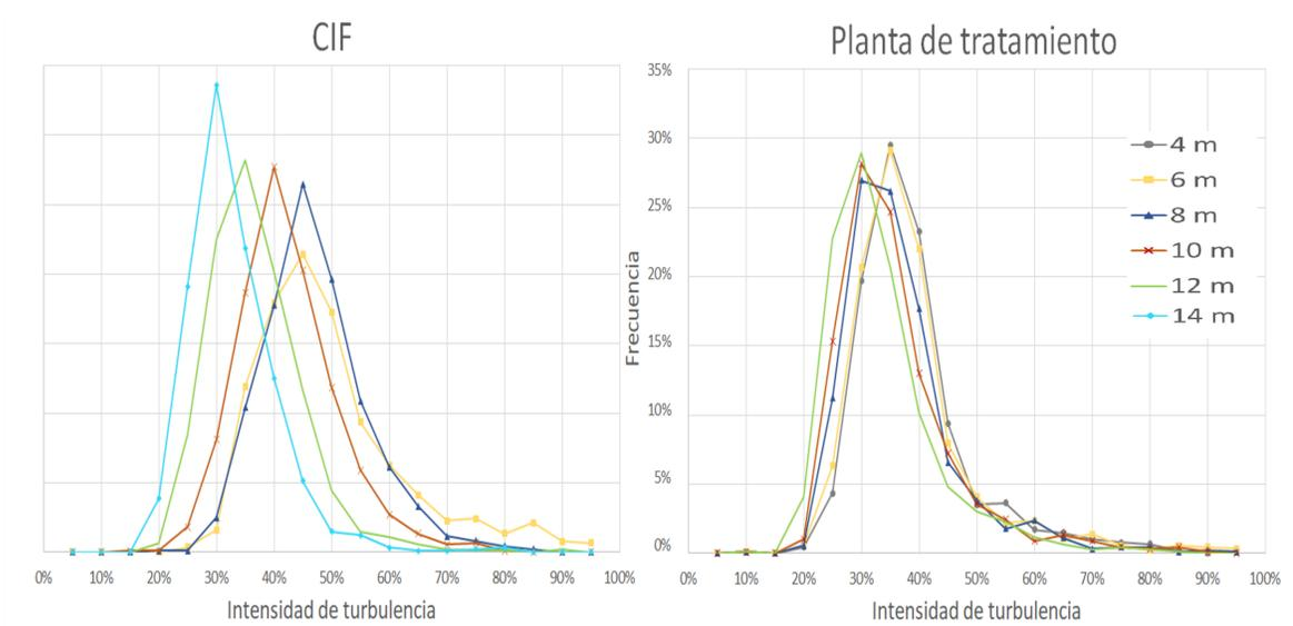
Figura 2.7: Histogramas de la intensidad de turbulencia en ambas torres de medición en el mes de marzo de 2019, CIF a la izquierda y Planta a la derecha.
