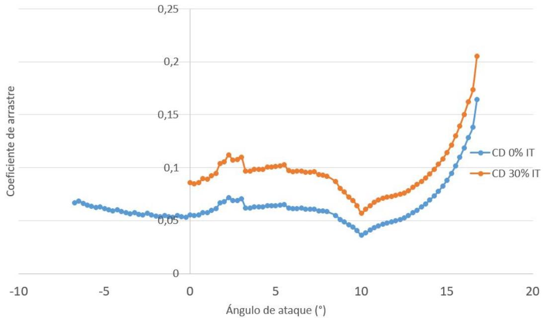
Figura C.10: Coeficiente de arrastre del perfil S809 para  $Re = 10^5$ .
