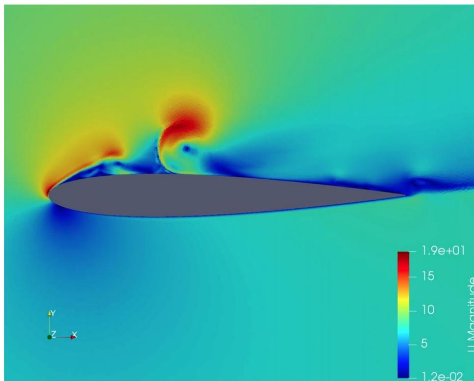
Figura 3.14: Campo de velocidad en el perfil NACA0012 con el modelo  $\gamma - Re_\theta$ .
