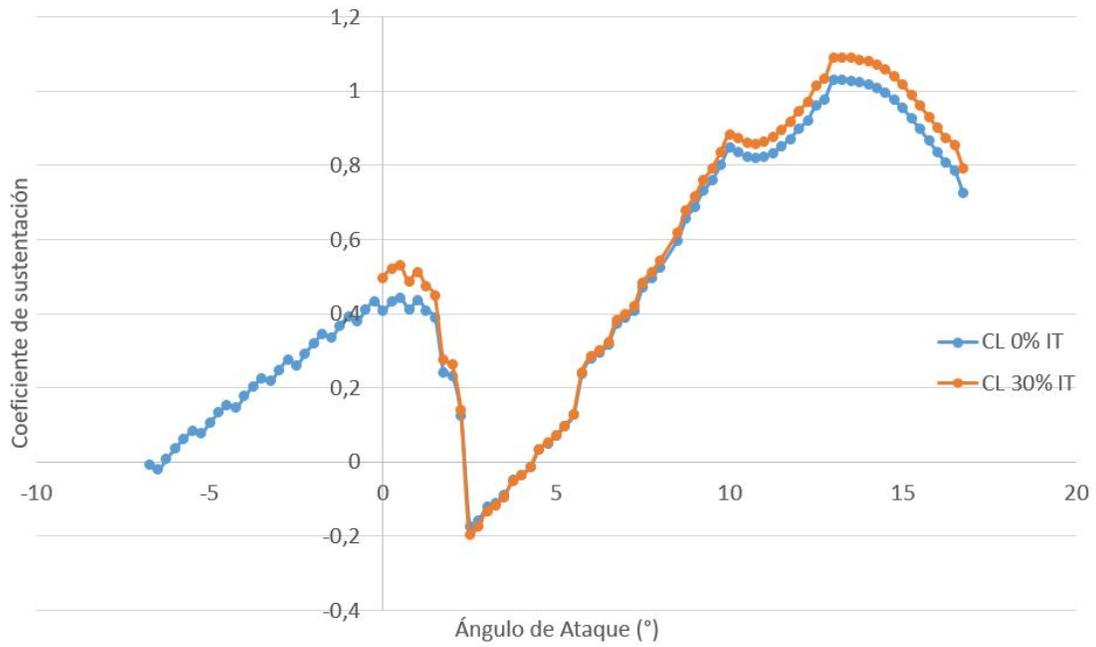
Figura C.9: Coeficiente de sustentación del perfil S809 para  $Re = 10^5$ .
