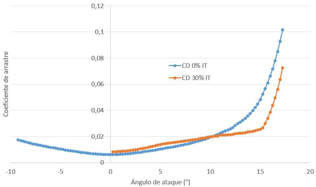
Figura C.8: Coeficiente de arrastre del perfil NACA0012 para  $Re = 5 \times 10^5$ .
