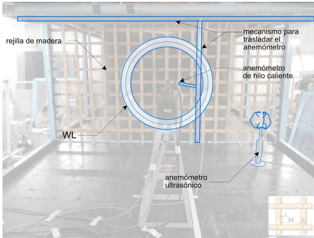
Figura 4.3: Elementos del montaje experimental.
