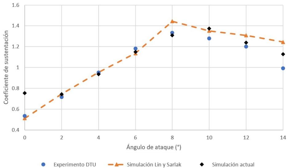
Figura 3.10: Validación de resultados con el  $C_L$  en el perfil S826.
