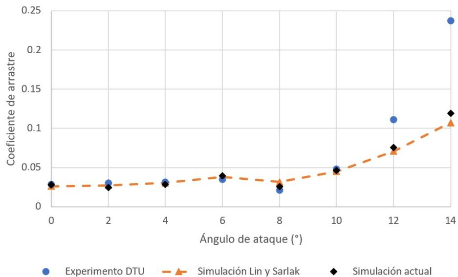
Figura 3.11: Validación de resultados con el  $C_D$  en el perfil S826.
