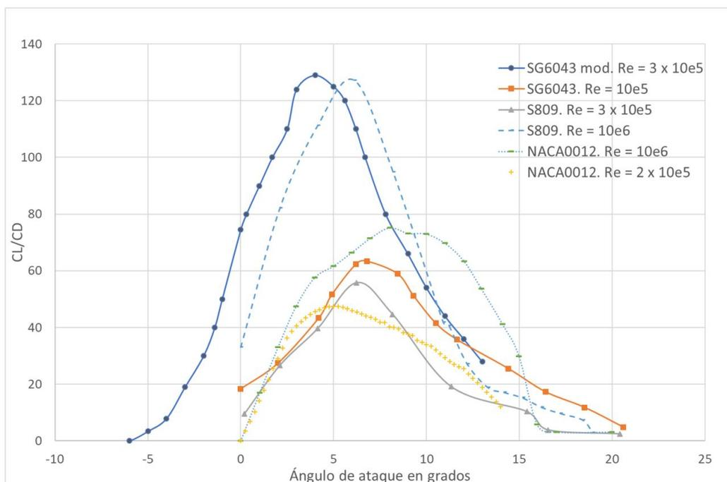
Figura 3.1: Relación de coeficiente de sustentación sobre coeficiente de arrastre para los perfiles SG6043, S809 y NACA0012 en distintas condiciones.
