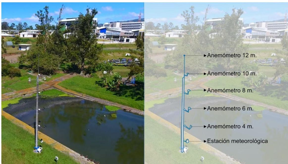
Figura 2.3: Torre Planta instrumentada con 5 anemómetros entre 4 y 12 m AGL.
