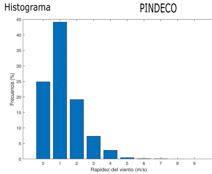
Figura B.65: Histograma de la velocidad del viento en PINDECO.
