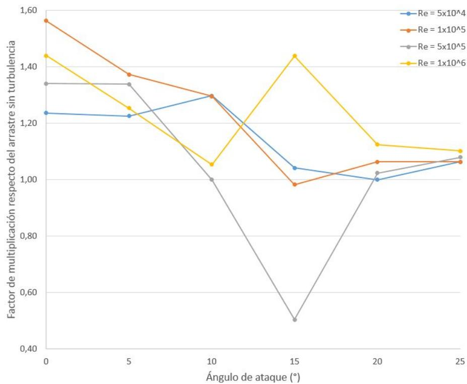
Figura 3.19: Variación del  $C_D$  del perfil NACA0012 para  $IT = 30\%$  respecto de  $IT = 0\%$ .
