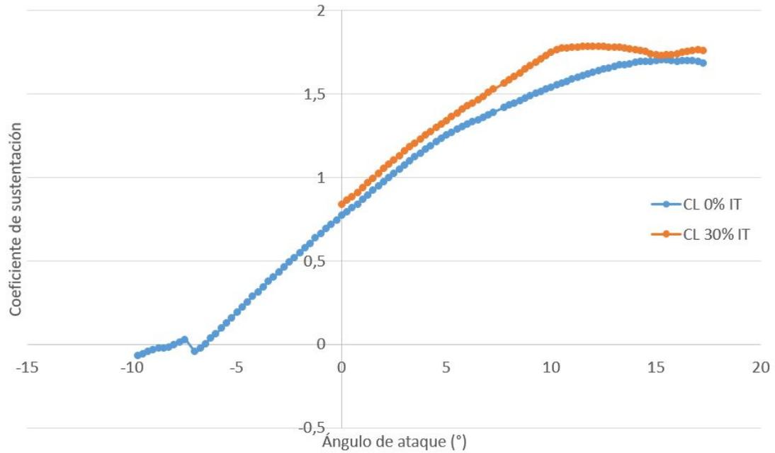
Figura C.3: Coeficiente de sustentación del perfil SG6043 para  $Re = 5 \times 10^5$ .
