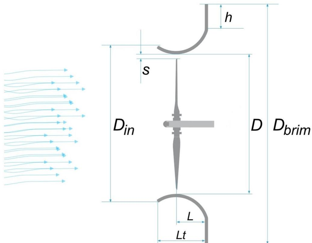
Figura 4.5: Esquema y dimensiones del Wind Lens.
