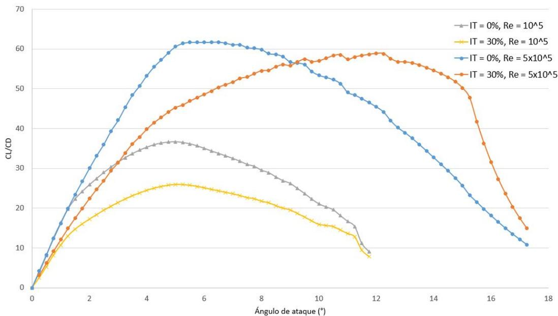
Figura 3.20: Relación entre sustentación y arrastre del perfil NACA0012 para  $IT = 30\%$  respecto de  $IT = 0\%$ .
