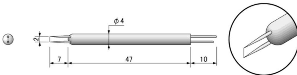
Figura 4.4: Anemómetro de hilo caliente, acotación en mm.
