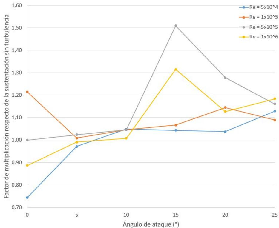
Figura 3.21: Variación del  $C_L$  del perfil S809 para  $IT = 30\%$  respecto de  $IT = 0\%$ .
