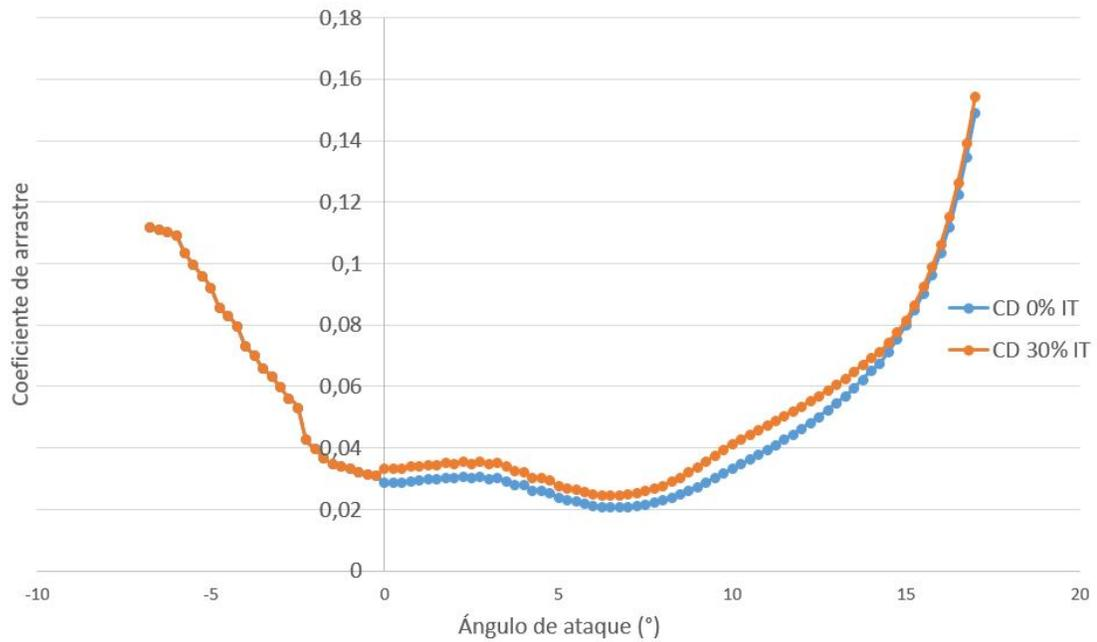
Figura C.2: Coeficiente de arrastre del perfil SG6043 para  $Re = 10^5$ .
