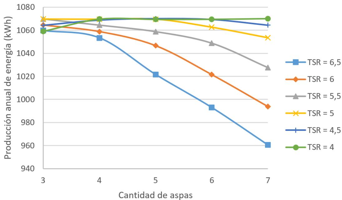
Figura 3.24: Producción anual de energía de los rotores con 3 a 7 aspas a distintos TSR.
