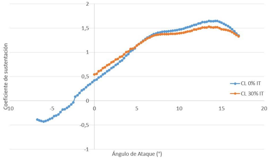
Figura C.1: Coeficiente de sustentación del perfil SG6043 para  $Re = 10^5$ .
