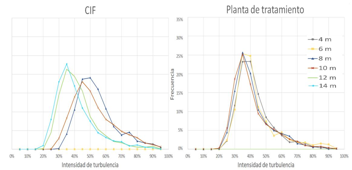
Figura 2.8: Histogramas de la intensidad de turbulencia en ambas torres de medición en el mes de mayo de 2019, CIF a la izquierda y Planta a la derecha.
