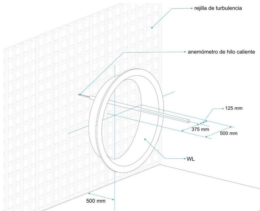
Figura 4.8: Perspectiva axonométrica de la colocación del hilo caliente dentro del WL.
