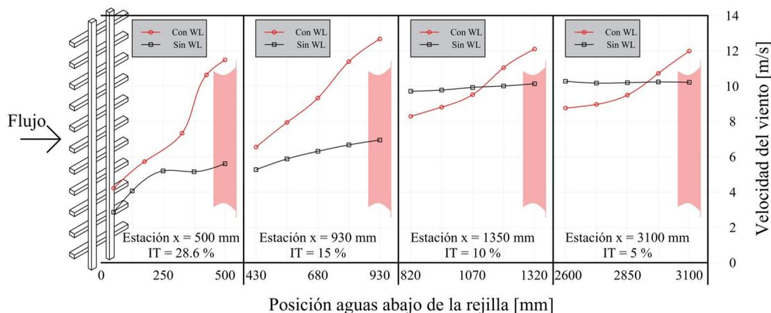
Figura 4.12: Efecto del Wind Lens en cuatro estaciones en flujo turbulento.
