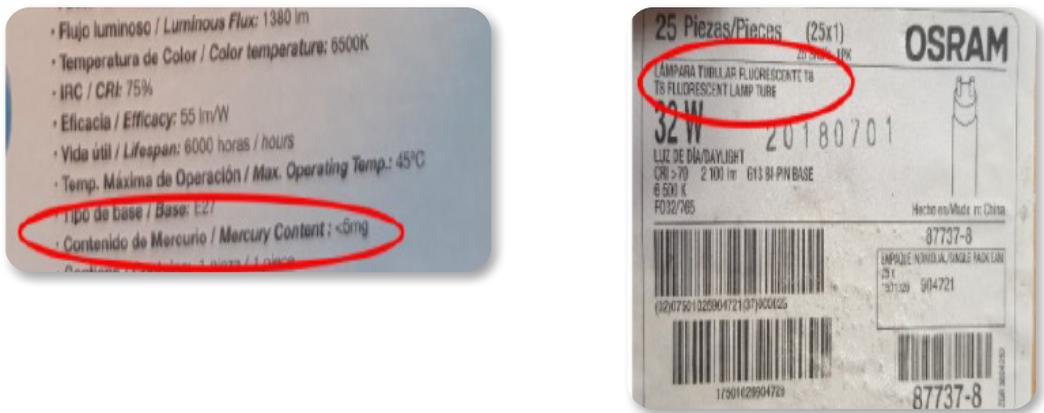
**Figura 14.** Verificación del contenido de mercurio presente en las lámparas adquiridas.
