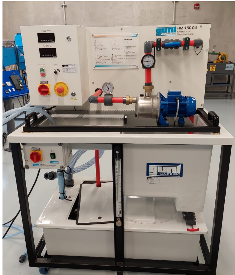
Figura 13: La bomba centrífuga y el banco de pruebas a usar en la adquisición de datos. Este equipo es propiedad de la Escuela de Ingeniería Mecánica de la Universidad de Costa Rica.
