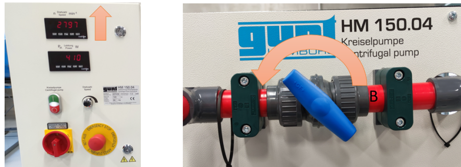
Figura 15: Los dos mecanismos disponibles para modificar el estado operativo de la bomba hidráulica. En la fotografía de la izquierda se muestra un variador de frecuencia con el cual es posible aumentar o disminuir la velocidad de giro de la bomba. En la fotografía de la derecha se muestra la válvula de descarga que regula el flujo de agua a la salida de la bomba.
