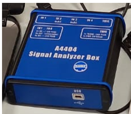
Figura 12: Módulo de adquisición de vibraciones modelo SAB de la marca ADASH.
