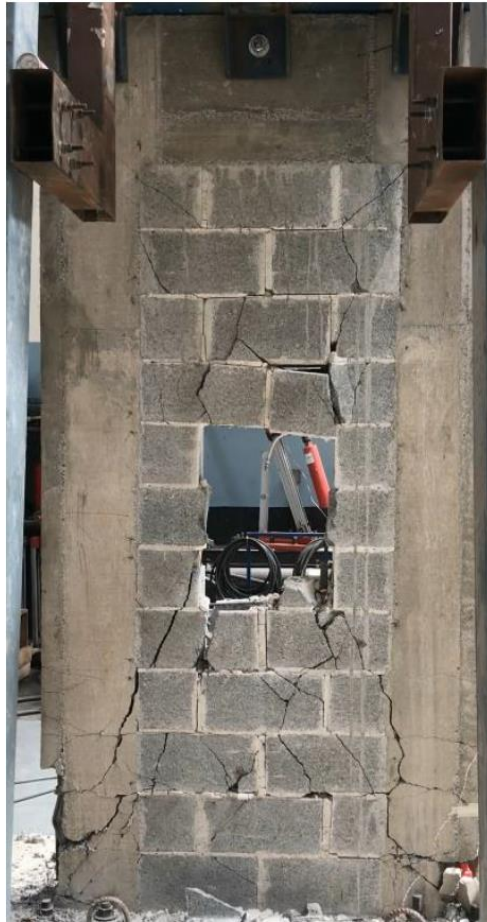
Figura F-5. Muro E después de la falla.
