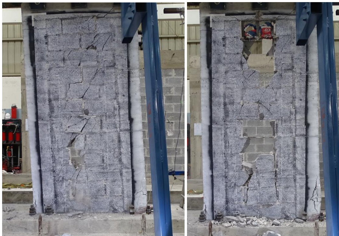
Figura F-8. Muro J durante y después de la falla.
