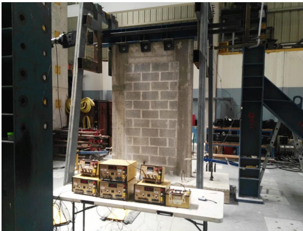
Figura 1-29. Espécimen montado en piso fuerte del laboratorio
