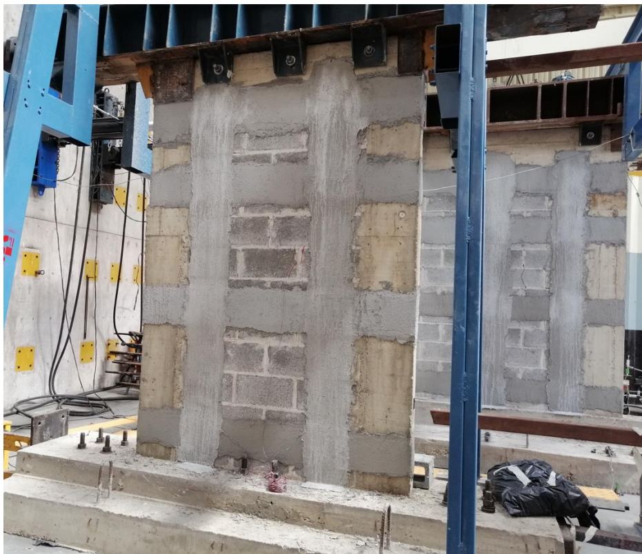
Figura F-26. Muros L' (atrás) y N' (adelante) antes de la falla.
