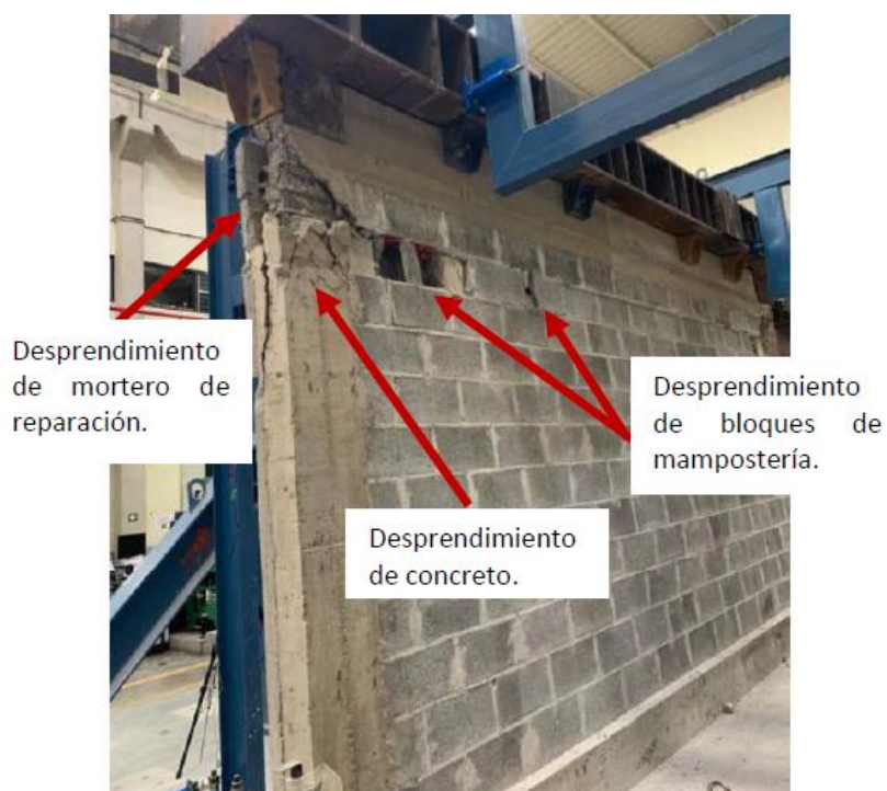
Figura F-24. Muro K' después de la falla.
