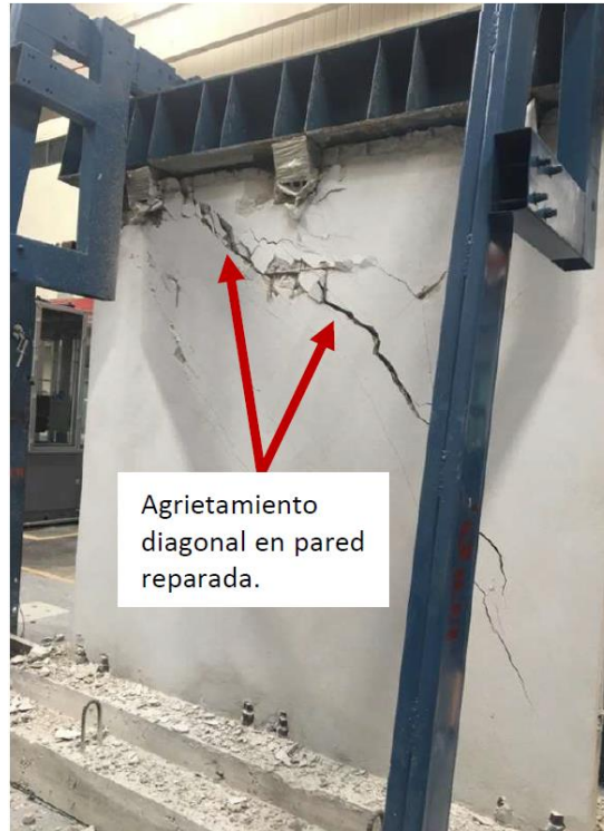
Figura F-29. Muro M' después de la falla.
