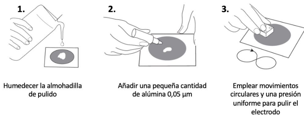
Figura 8. Metodología empleada para pulir los electrodos sólidos de carbón vítreo. Imagen tomada, traducida y modificada de Bioanalytical Systems, Inc, 2001
