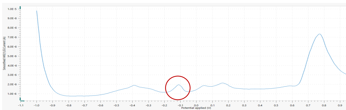
Figura 25. Voltamperometría diferencial de pulso (DPV) para la disolución amortiguadora de acetato de sodio. 0,1 \text{ mol}\cdot\text{L}^{-1} , pH 4,5, con la metodología de gota sobre el electrodo de carbón serigrafado [ 0,13 \text{ cm}^2 ] con película delgada de oro
