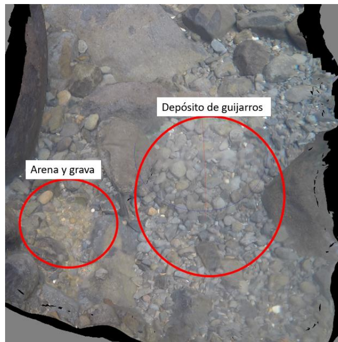
Figura 33. Utilidad del modelo 3D sumergido para la identificación de tamaños de partículas. La figura muestra dos depósitos con partículas de diferente tamaño. Elaboración propia.
