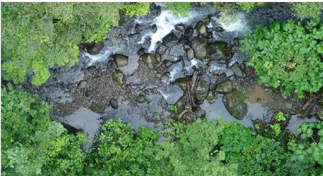
Figura 11: Ejemplo de un ortomosaico de baja altitud (30m) en una sección del río San Lorencito. Elaboración propia.
