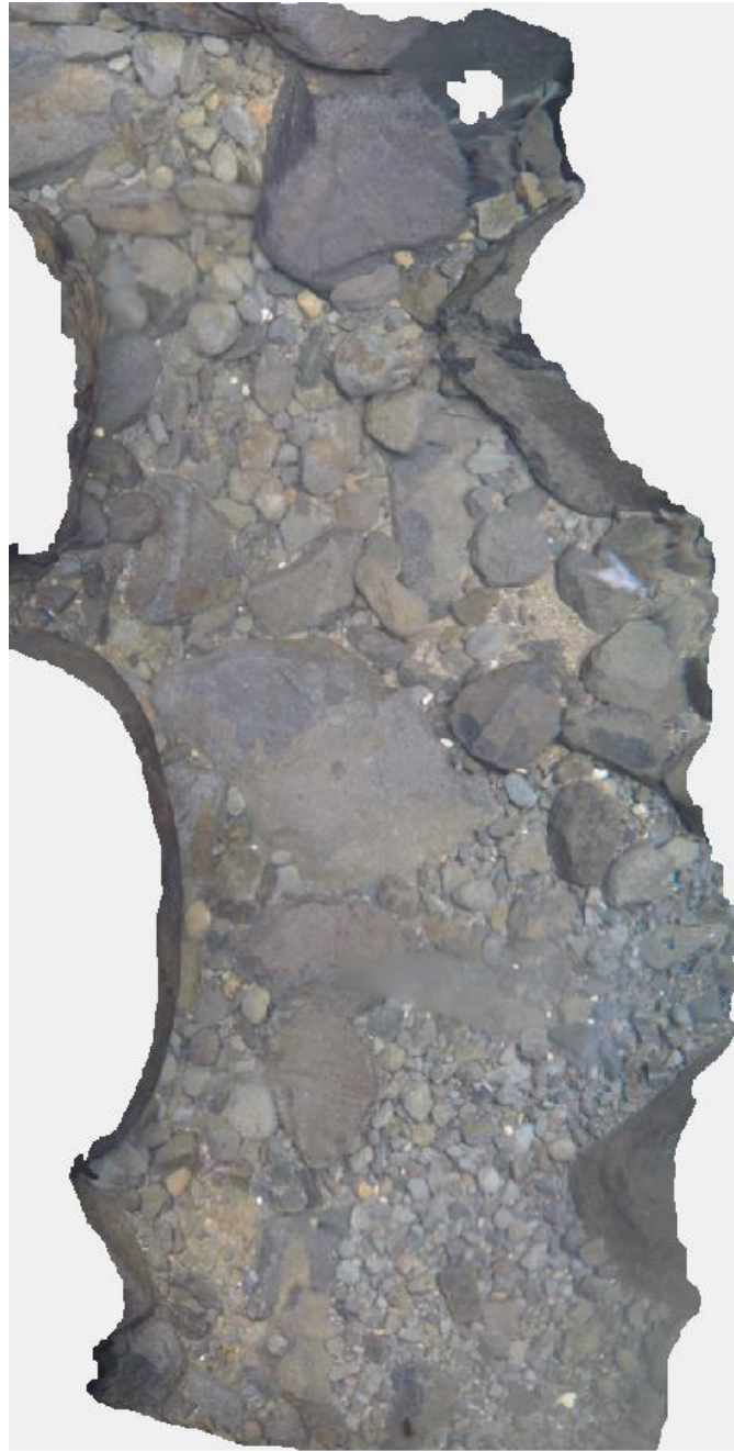
Figura 30. Ortomosaico fotogramétrico de una sección del lecho del río San Lorencito. A partir de 27 imágenes digitales sumergidas se logró elaborar un ortomosaico fotogramétrico
