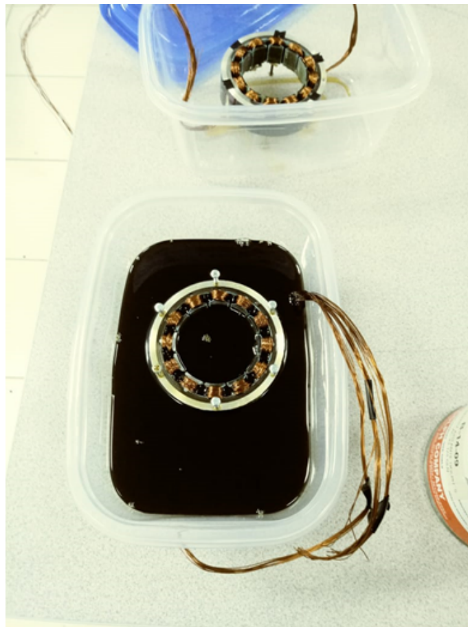
Figura 4.23. Aislamiento del devanado y el estator usando barniz dieléctrico.
