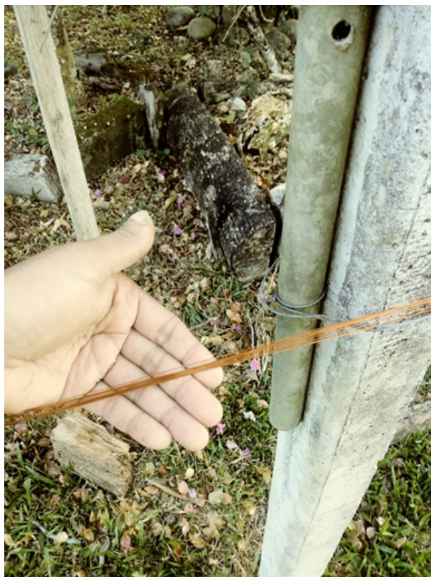
Figura 4.21. Proceso de devanado del actuador.
