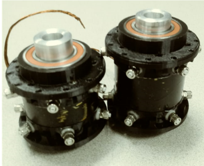
Figura 4.25. Dos actuadores del tipo BLDC de 20 mm y 40 mm de longitud.
