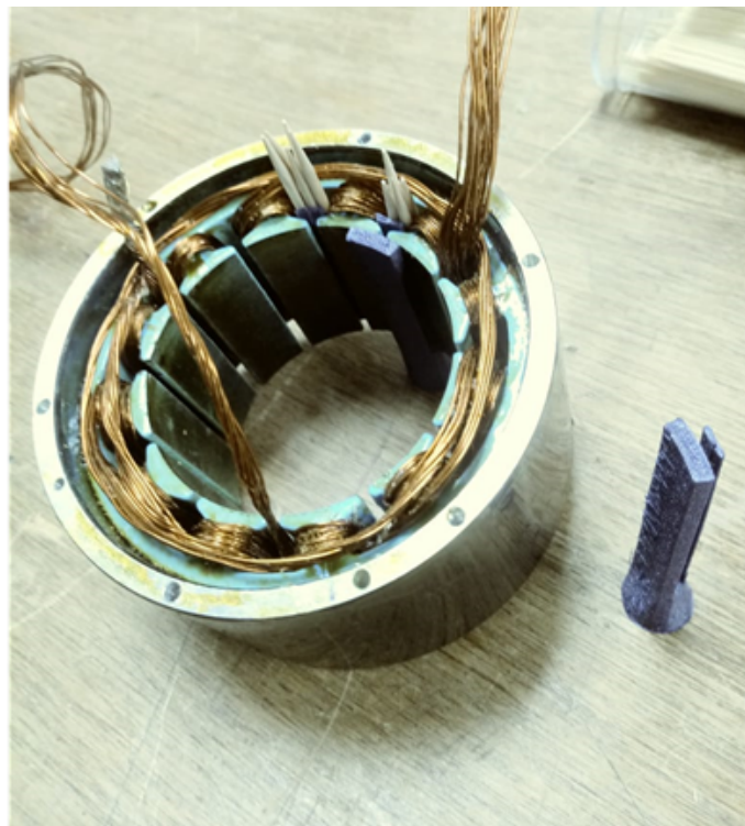
Figura 4.26. Devanado del motor del estator BLDC.
