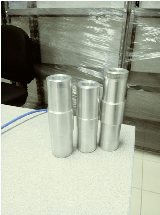
Figura 4.24. Rotores mecanizados en aluminio 6061-T6.
