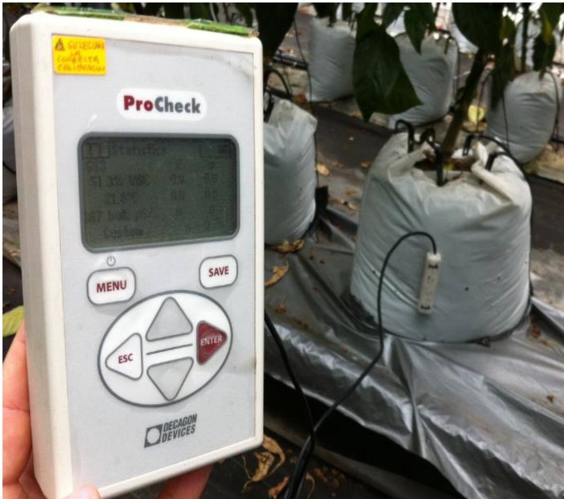
Figura 5. Sensor TDR (Time Domain Reflectometry) conectado a consola GS3 Decagon Devices, para medir el contenido de humedad volumétrica en el sustrato.
