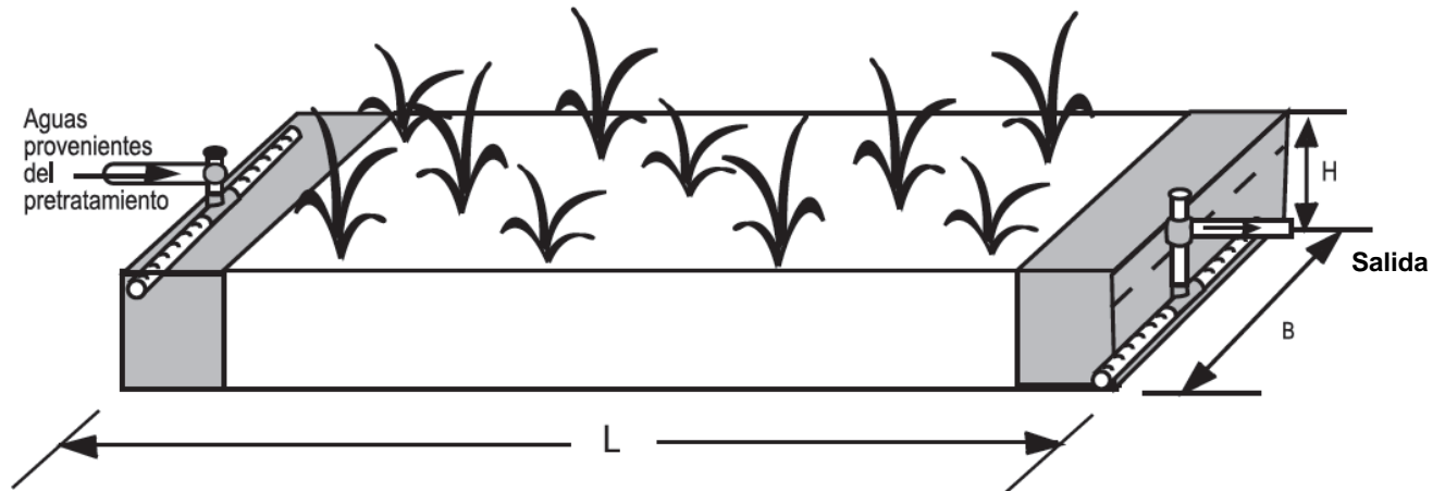
Figura 8-6.14 Principio de funcionamiento de una jardinera para tratar aguas residuales. Fuente: ISSUE, 2006.
