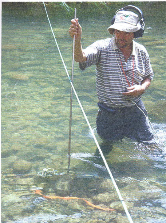
Foto A5: Medición de profundidad y velocidad de corriente
