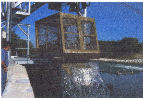
Figura B1 : Funcionamiento del ascensor para peces, esquema y foto
