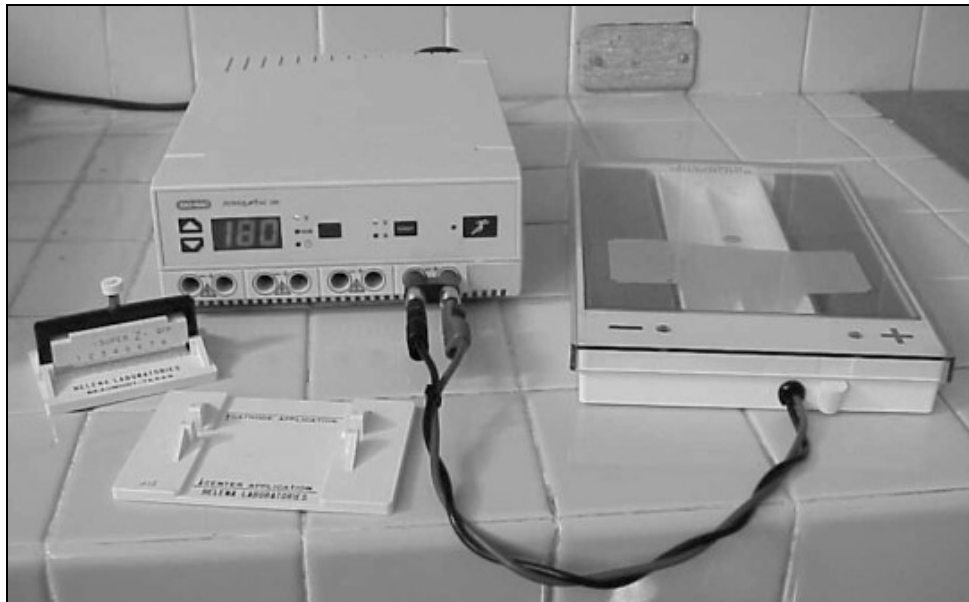
Figura 11.6: Fuente de poder y cámara para electroforesis en poliacetato de celulosa. La fuente de poder (izquierda) se conecta a los electrodos de la cámara (derecha), observando la polaridad correcta. La cámara tiene una tapa acrílica transparente que permite visualizar la corrida de las muestras, a la vez que previene accidentes por descargas eléctricas.
