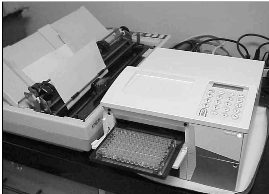
Figura 10.10: Lector automático de placas de 96 hoyos. Estos espectrofotómetros utilizan un sistema de haces de luz múltiples, perpendiculares a la placa, que permiten leer la absorbancia de los 96 hoyos en menos de 10 segundos. Las lecturas pueden ser enviadas a una impresora, o mejor aún, a una computadora, en donde pueden procesarse y almacenarse. Los lectores poseen un conjunto de filtros para seleccionar la longitud de onda apropiada, y son útiles en muy diversas técnicas, además del ELISA.
