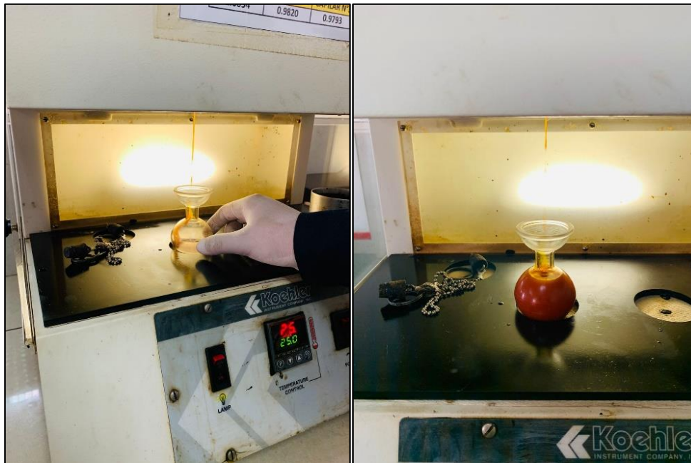
Figura 13. Ensayo de Viscosidad Saybolt Furol para Aceite crudo de palma.
