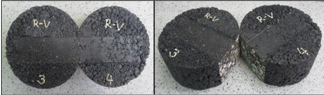
Figura 44. Especímenes de mezcla con AP (0.5%) después del ensayo de Rueda de Hamburgo.
