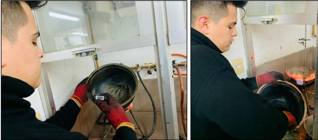
Figura 18. Proceso de mezclado con control de temperatura en mezcla.
