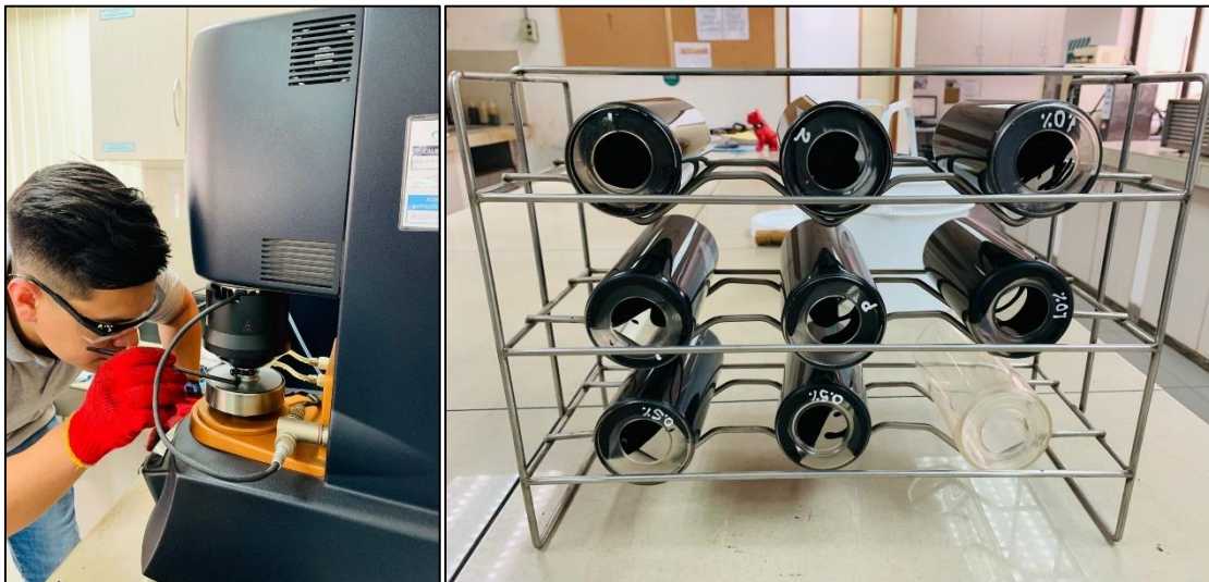
Figura 26. Proceso de caracterización de ligante en DSR y muestras RTFOT.
