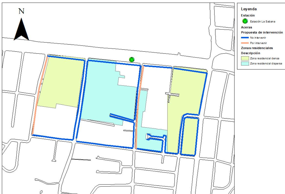
Figura 54. Necesidad de intervención de las aceras en la estación Sabana
