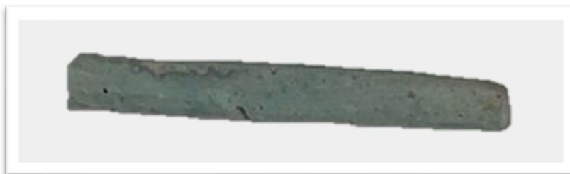
Figura 31. Cemento con 0 % de \text{TiO}_2 posterior a la exposición con azul de metileno a 60 minutos de radiación bajo lámpara UV.
