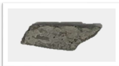
Figura 33. Cemento con 5 % de \text{TiO}_2 posterior a la exposición con azul de metileno a 60 minutos de radiación bajo lámpara UV.
