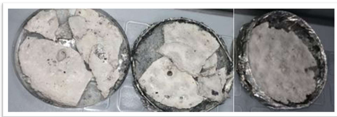
Figura 11. Muestras de cemento fotocatalítico creadas con Pegamix.
