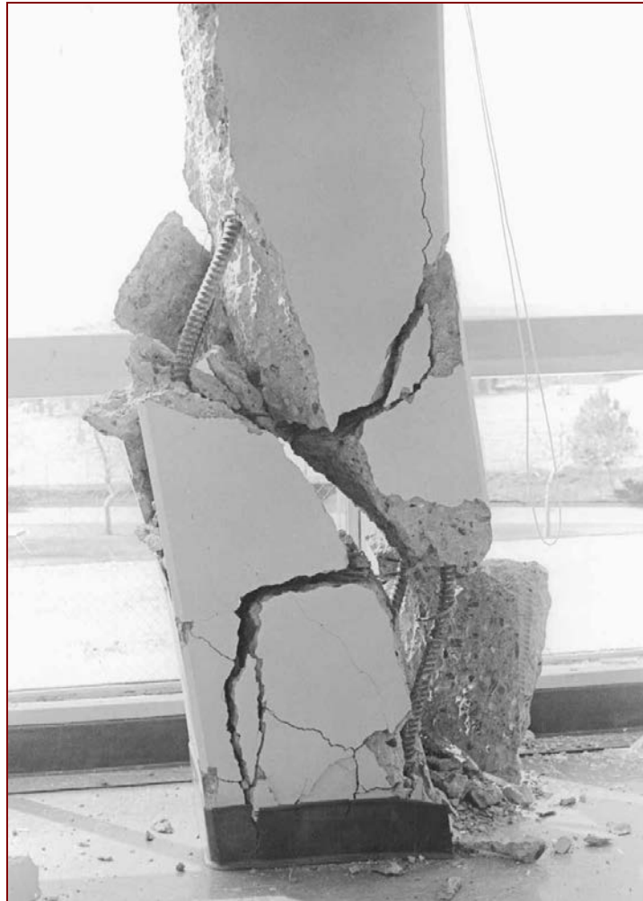
Figura 5–28 Falla de cortante de columna con aros rectangulares, terremoto de San Fernando, CA, 1971. (Fotografía cortesía de J. G. MacGregor.)
