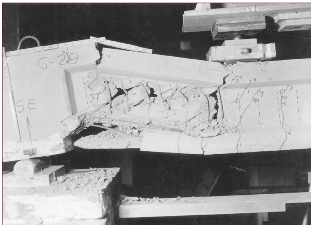
Figura 5-18 Falla por aplastamiento del concreto del alma. (Fotografía cortesía de J. G. MacGregor.)
