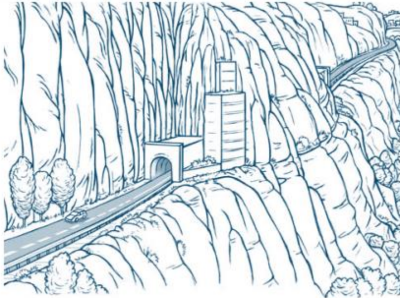
Imagen 105: El túnel tiene una presencia paisajística muy reducida si no se construyen de la manera adecuada, sobre todo en tres puntos importantes; la gestión de las obras, el volumen del movimiento de tierras y la integración de sus entradas al entorno.
