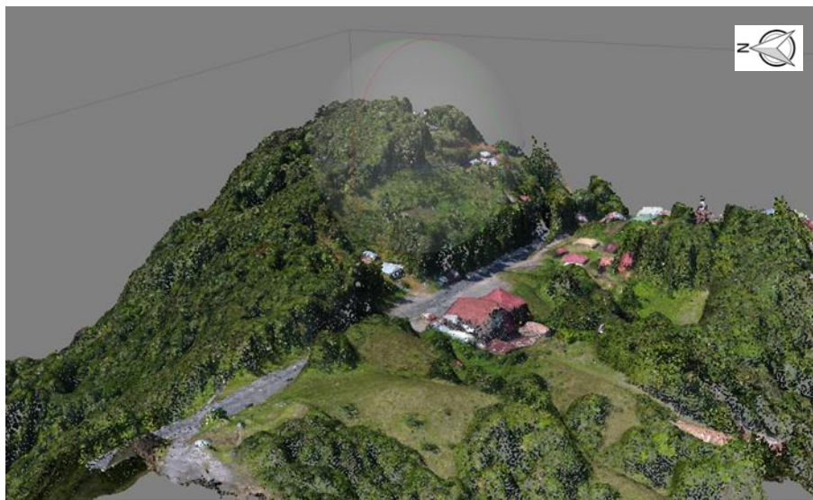
Figura 34. Nube densa con la representación de la escena en 3D. Fuente: Elaboración propia, 2020.
