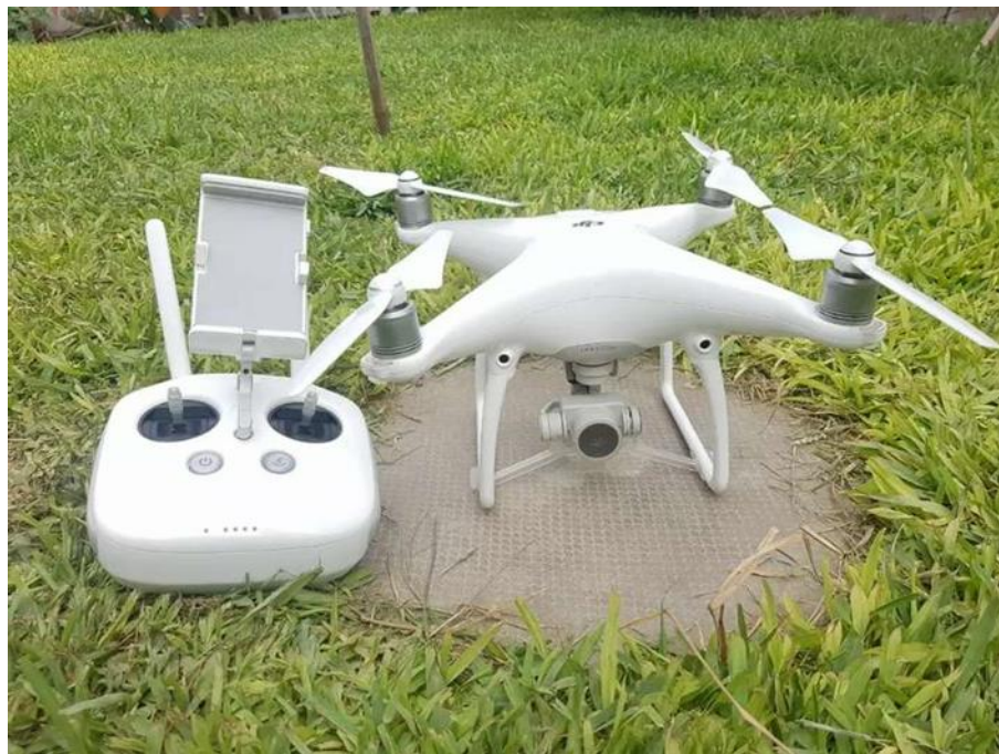
Figura 14. El modelo VANT Phantom 4 Standard utilizado en el sector de Casamata. Fuente: AERPAS, 2020.
