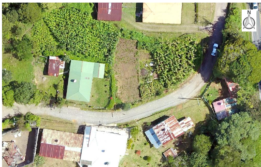
Figura 40. El Ortomosaico es un elemento ráster de alta resolución espacial.
