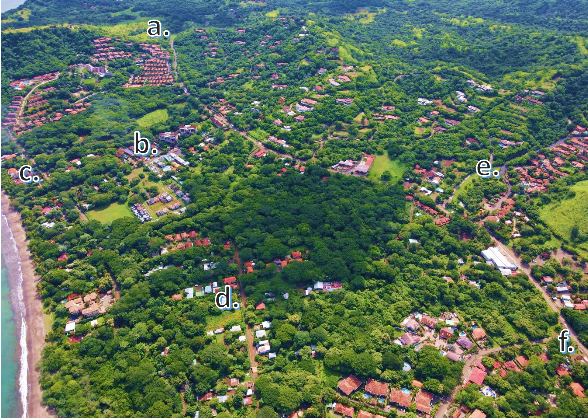
Figura 9. Infraestructura vial presente en Playa Hermosa, Guanacaste. a. Ruta Nacional 159, b. Calle pública principal pavimentada, c. calles pública secundarias pavimentada, d. Calles pública secundaria de lastre, e. calles privadas residenciales, f. Ruta Nacional 151. Fuente: Elaboración propia fotografías aéreas Michel Palmer, 2021.
