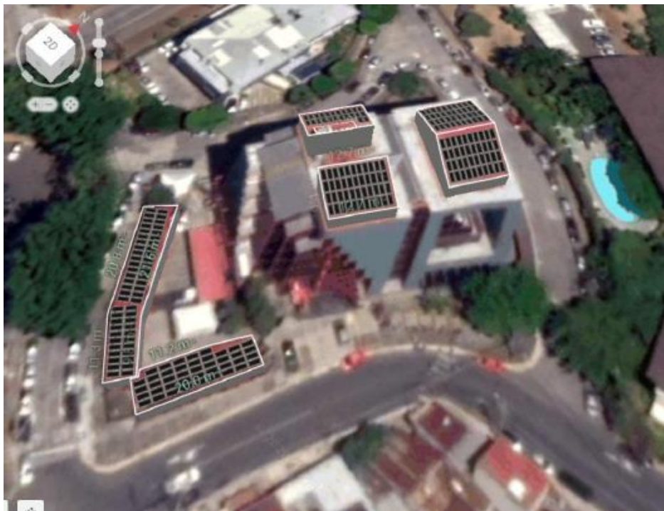
Ilustración 36. Propuesta instalación de sistema fotovoltaico. Programa Aurora
