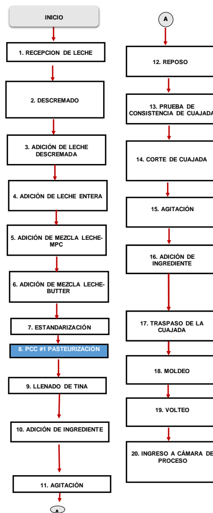
Imagen 3. Flujo de proceso de la realización de queso tipo Turrialba.
