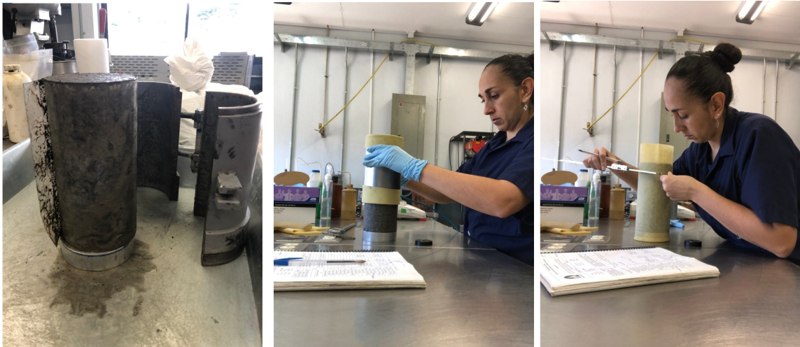
Figura 35. Preparación de especímenes utilizando membrana de acetato y medición de especímenes de módulo resiliente en bases estabilizadas con cemento posterior al curado
