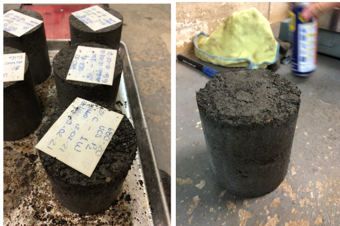
Figura 30. Desnudamiento en la base estabilizada debido a un rocío de los aspersores no uniforme sobre los especímenes en la cámara húmeda
