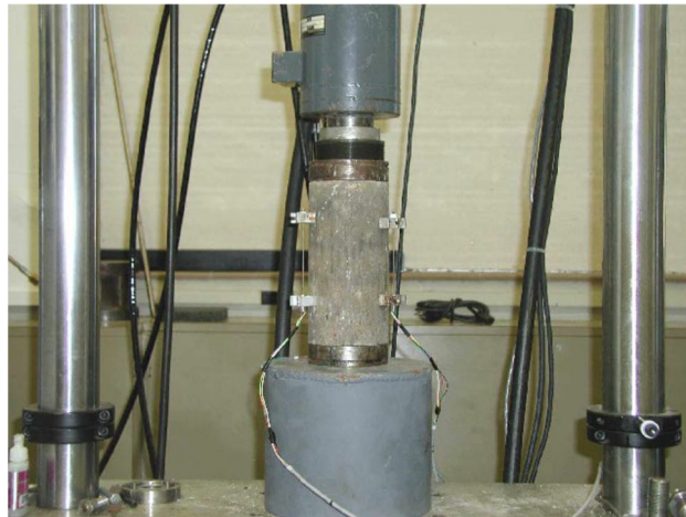
Figura 9. Medición de las deformaciones a compresión para un espécimen de BEC (Lim & Zollinger, 2003)
