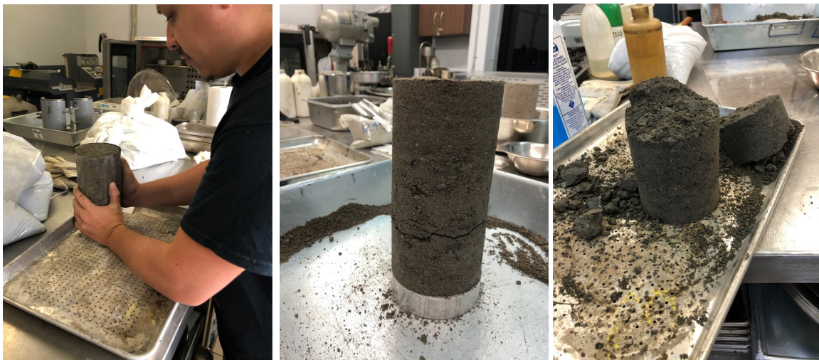
Figura 32. Complicaciones en la compactación de los especímenes con bajo contenido de humedad
