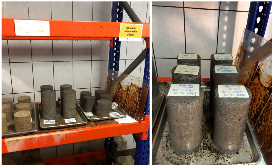
Figura 27. Curado de especímenes antes de cada ensayo de resistencia: 7 días y 28 días
