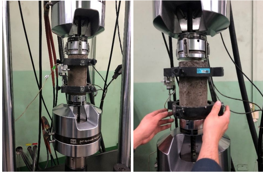
Figura 9. Medición de las deformaciones a compresión para un espécimen de BEC (Lim & Zollinger, 2003)
