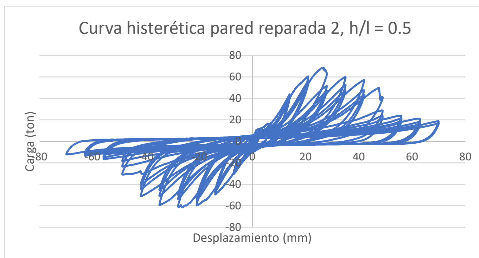
Figura 89. Curva histórica del muro h/l = 0.5 , pared reparada 2.
