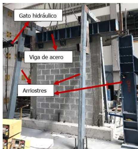
Figura 16. Montaje de pared h/l = 1 .
