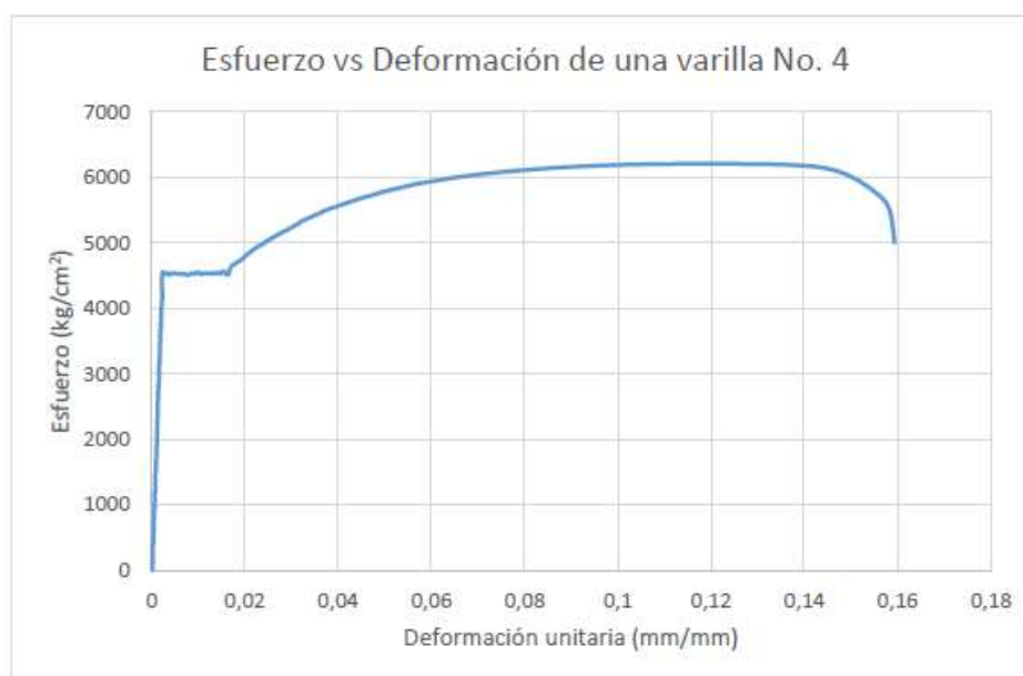
Figura 37. Curva esfuerzo deformación de una varilla No 4.
