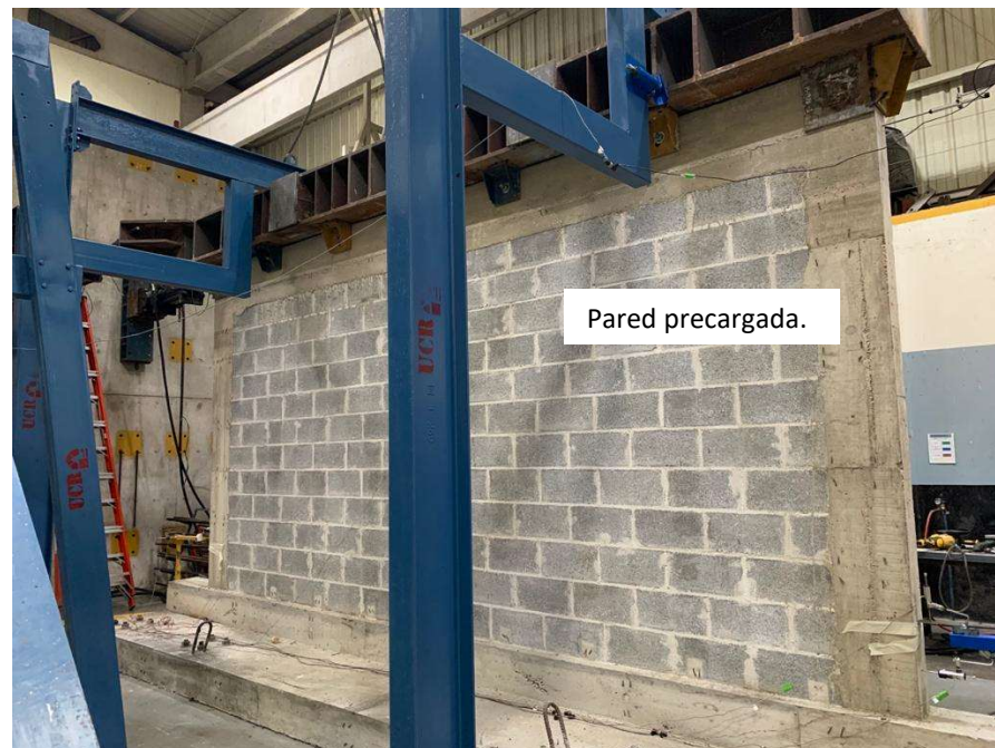
Figura 84. Precarga del muro h/l = 0.5 , pared precargada 2.
