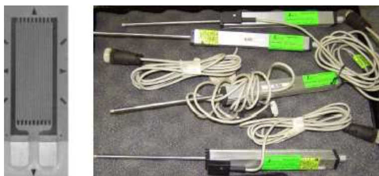
Figura 10. Galga extensométrica y LVDT, tomado de Laboratorio de Estructural del LanammeUCR.
