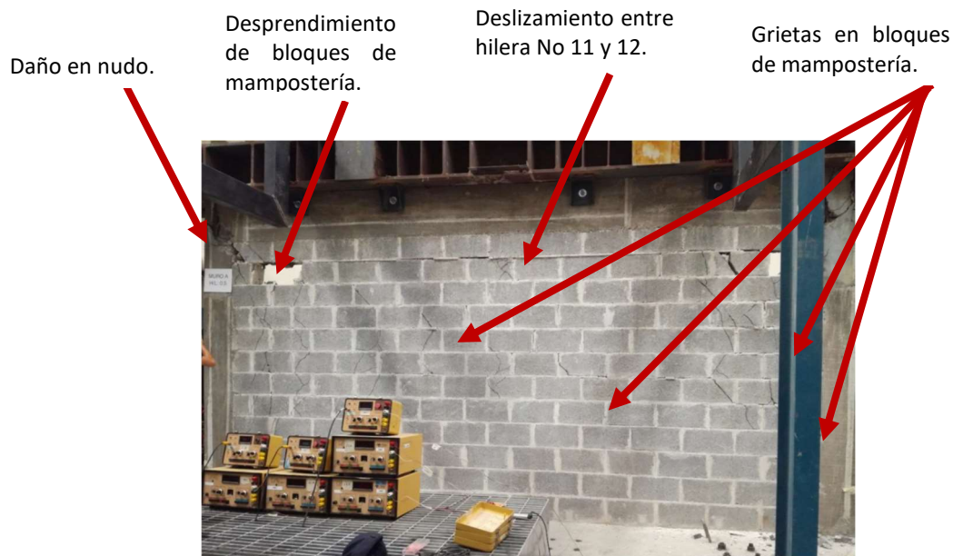
Figura 62. Muro fallado h/l = 0.5 , pared patrón.
