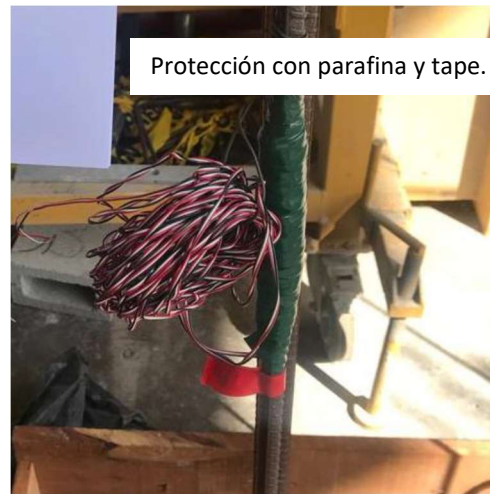
Figura 13. Colocación de galgas extensométricas.
