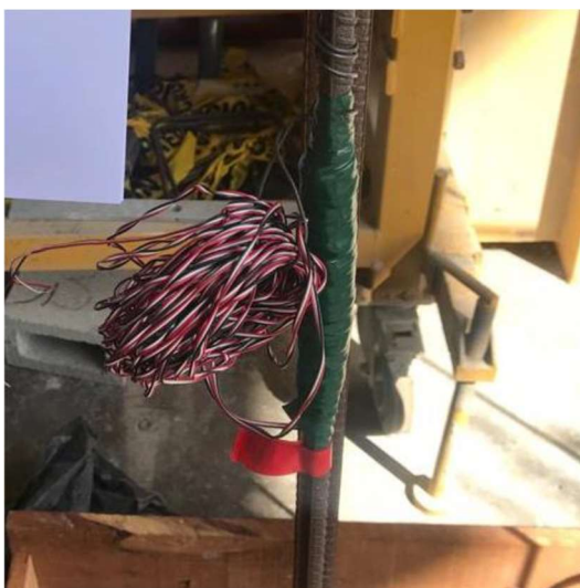
Figura 43. Colocación de galgas extensométricas en varillas.
