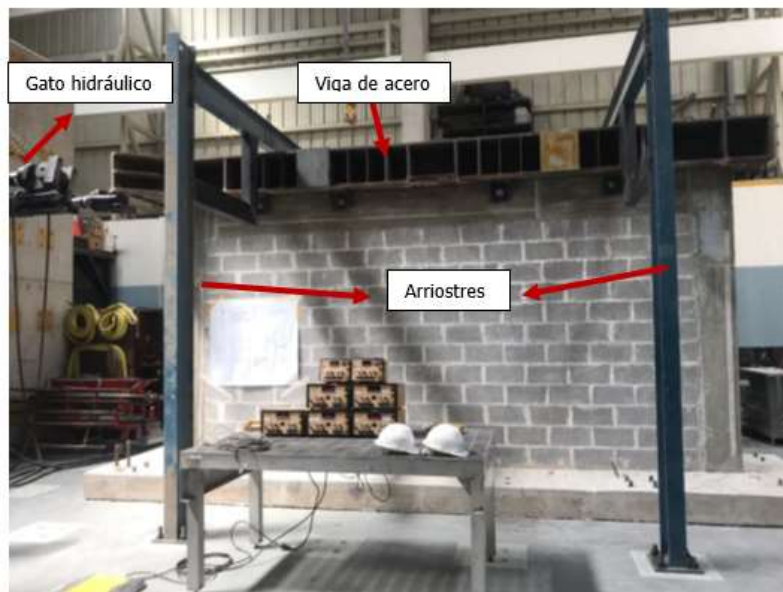
Figura 18. Montaje de pared h/l = 0.5 .
