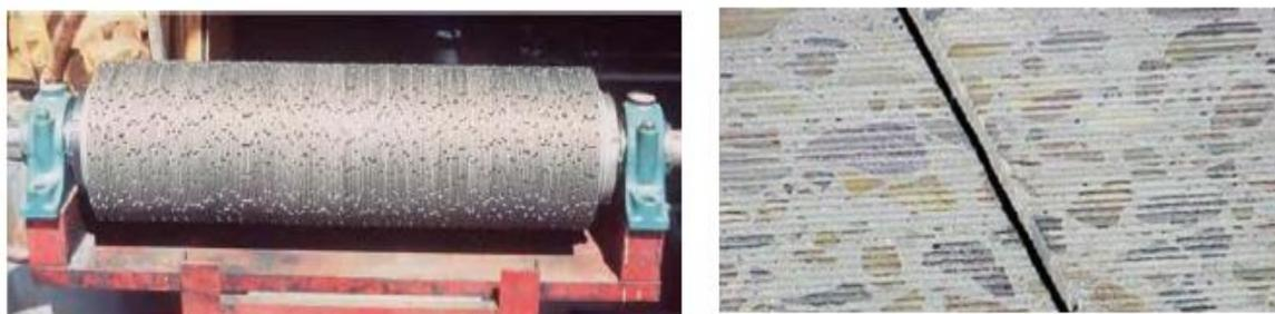
**Figura 30.** Componentes y superficie después del cepillado superficial.
