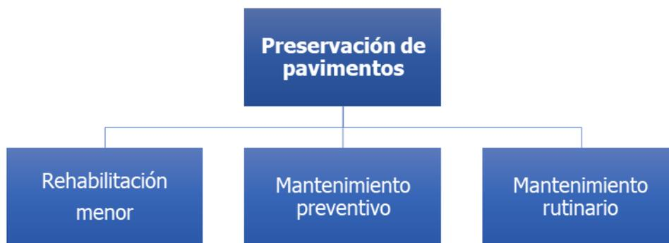
**Figura 12.** Componentes de la preservación de pavimentos
