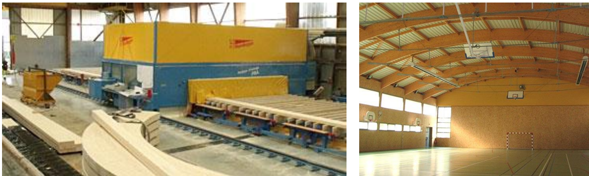
Figura 201. Modelado de la madera estructural realizando una curva en planta de proceso. (Maderamen, 2017).
