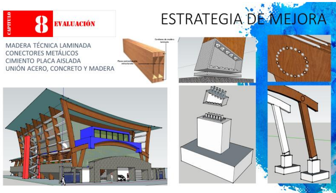
Figura 152. Aplicación de estructura en madera técnica laminada estructural. Elaborado por el autor, (2018, revisado en 2020).
