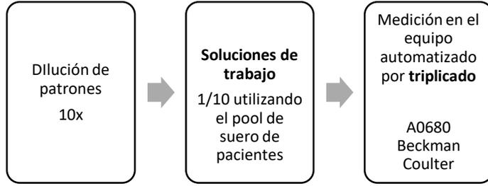
**Figura 4. Esquema de trabajo para la realización del estudio de interferencias en la determinación sérica de creatinina por el método modificado de Jaffe.**
