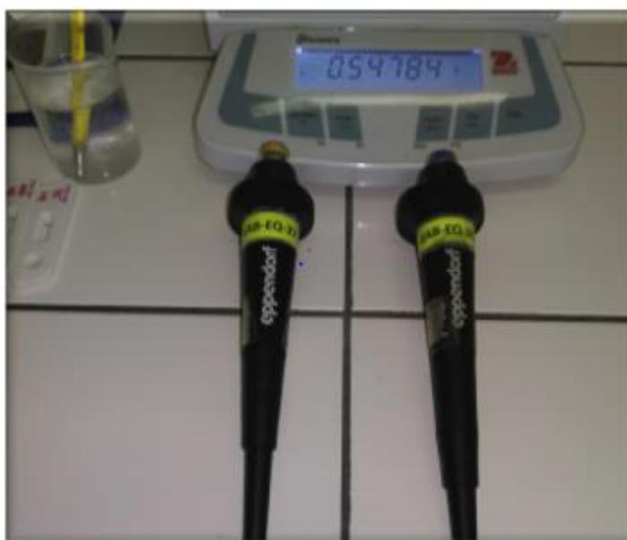
Figura 5. Pipetas y balanza analítica utilizada para el procedimiento.
