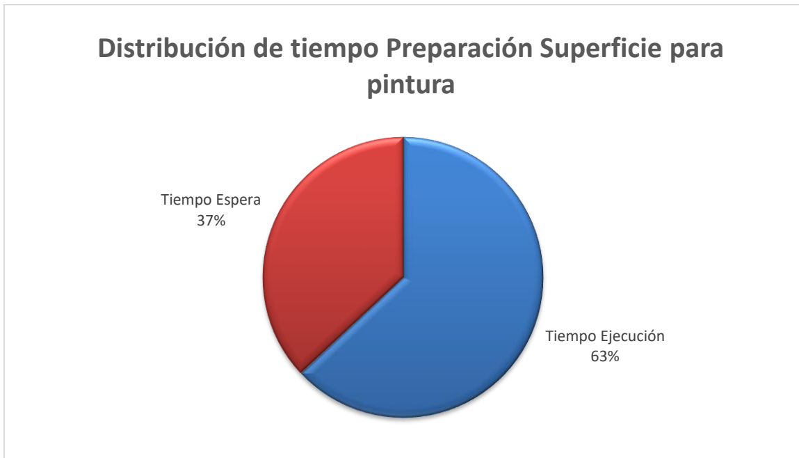
Figura 4-30. Distribución porcentual del tiempo promedio de la preparación de la superficie en el proceso de pintura de estructuras de concreto
