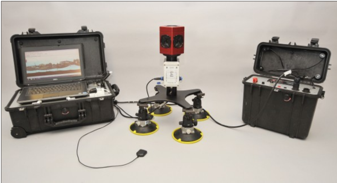
Figura 12: GFZ-MOMA, de izquierda a derecha: computadora portátil, cámara omnidireccional y banco de baterías.
