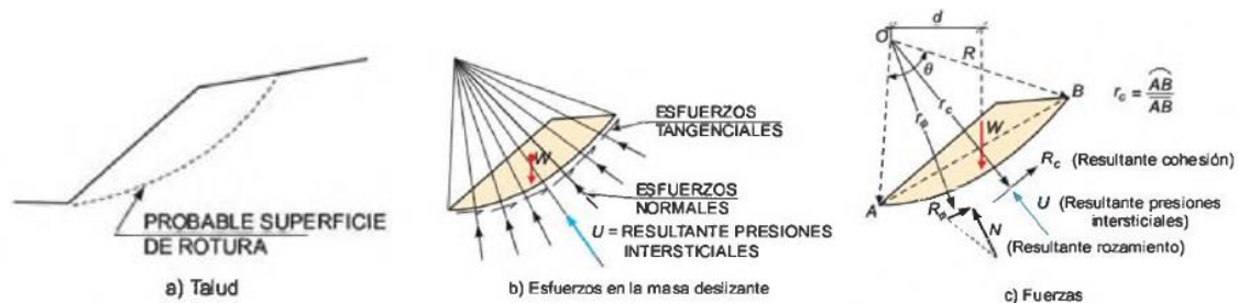
Figura II-78. Fuerzas que actúan sobre una superficie de rotura curva. Fuente: González de Vallejo, Ortuño y Oteo (2002).
