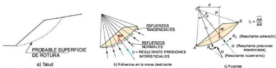
Figura II-41. Fuerzas que actúan sobre una superficie de rotura curva. Fuente: González de Vallejo, Ortuño y Oteo (2002).
