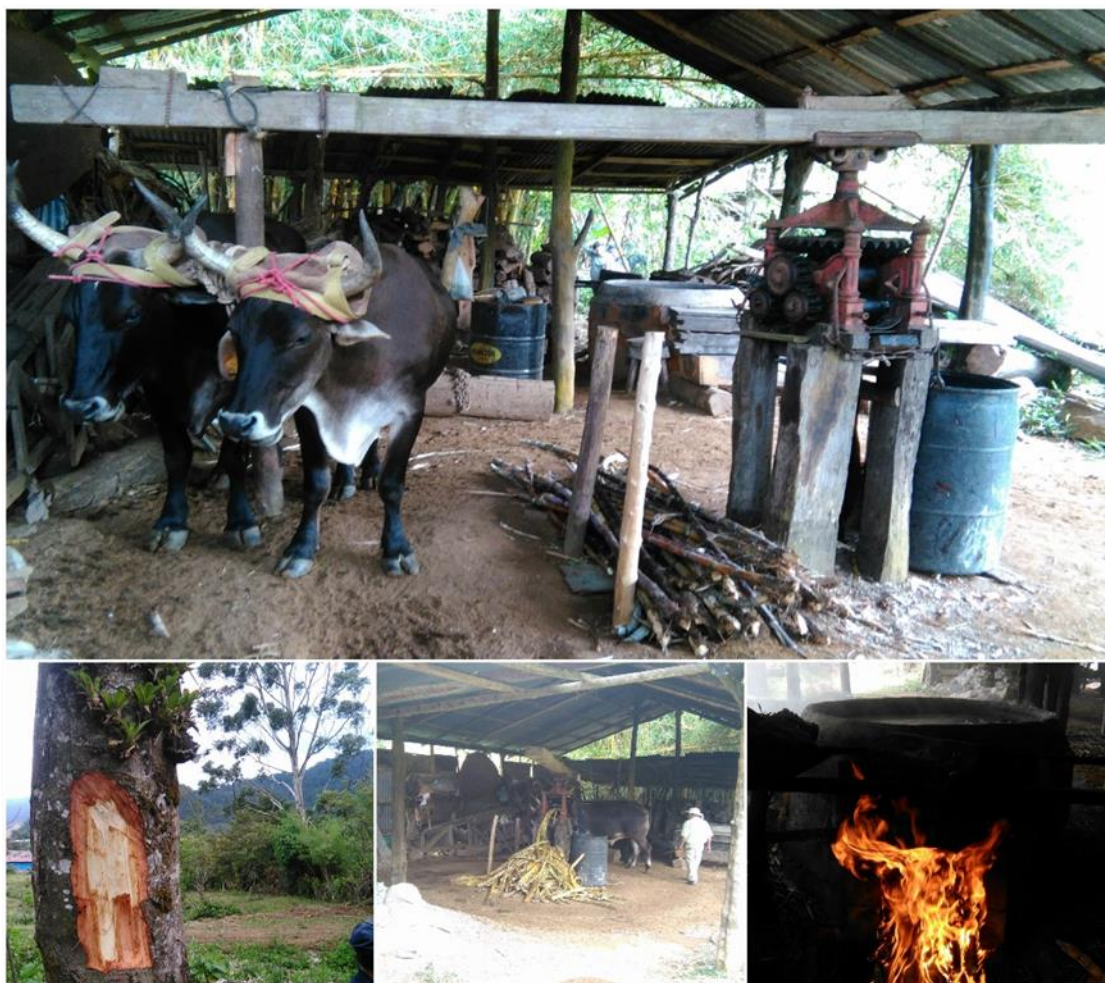
Figura 49: Proceso de generación de dulce de caña por medio de un trapiche que funciona con bueyes. Familia Marín Jiménez, Cedral de Miramar.
