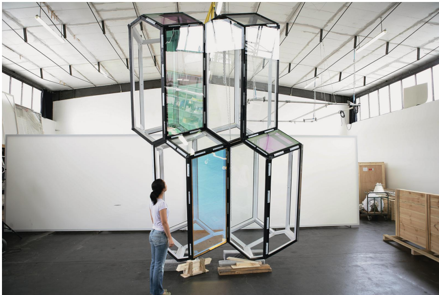
Fig. 8. Prototipos de cuasi-ladrillo para el Auditorio y Centro de Conferencias Harpa .
