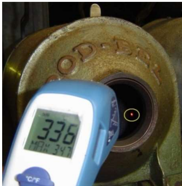
Figura 1 - Medição da temperatura na parede interna do torrador.
