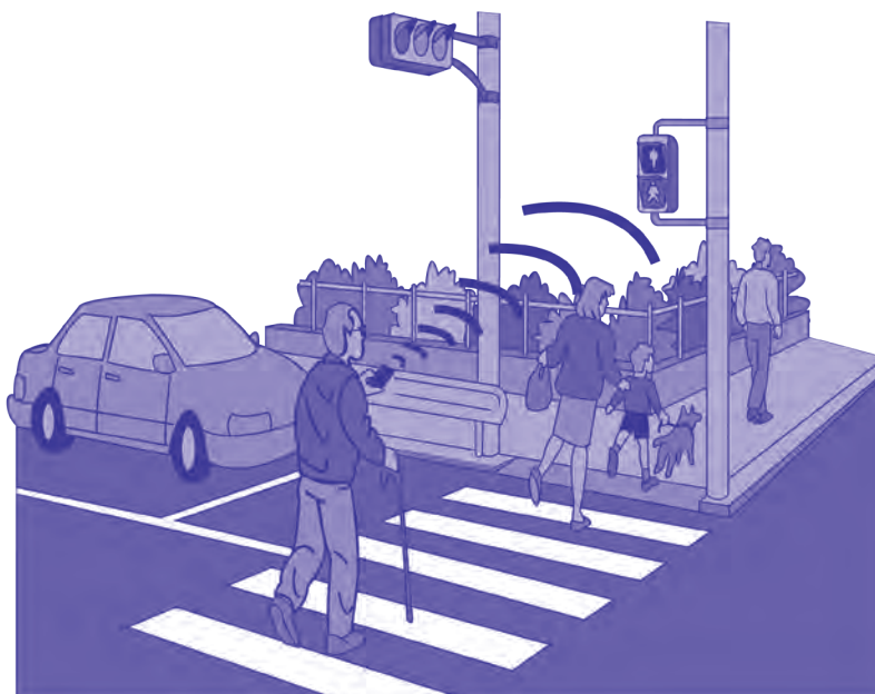
Figura 6.3 Dispositivo portátil para alargar el tiempo de la fase peatonal
