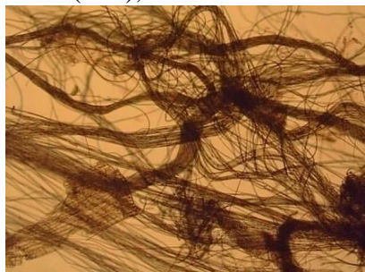
Figura 6.4 Micrografía de la muestra de rastrojo pretratada con hidróxido de sodio al 1,25% (m/v), aumento 4X.
