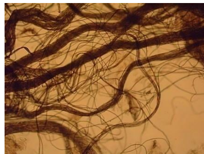
Figura 6.4 Micrografía de la muestra de rastrojo pretratada con hidróxido de sodio al 1,25% (m/v), aumento 4X.
