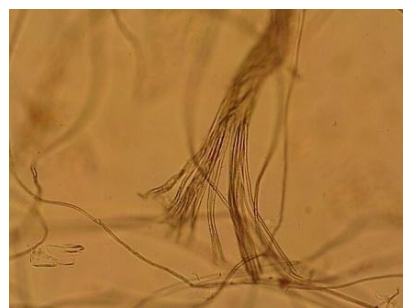
Figura 6.5 Micrografía de la muestra de rastrojo pretratada con hidróxido de sodio al 1,50% (m/v), a) aumento 4X, b) aumento 10X.
