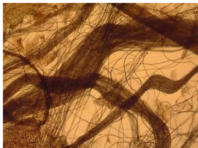
Figura 6.4 Micrografía de la muestra de rastrojo pretratada con hidróxido de sodio al 1,25% (m/v), aumento 4X.
