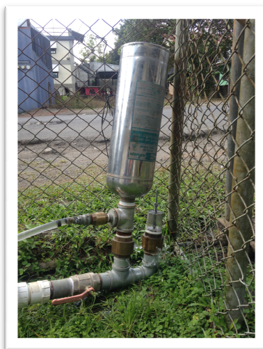
Figura 2. Ariete hidráulico universal fabricado por el Ing. Orlando Hernández
