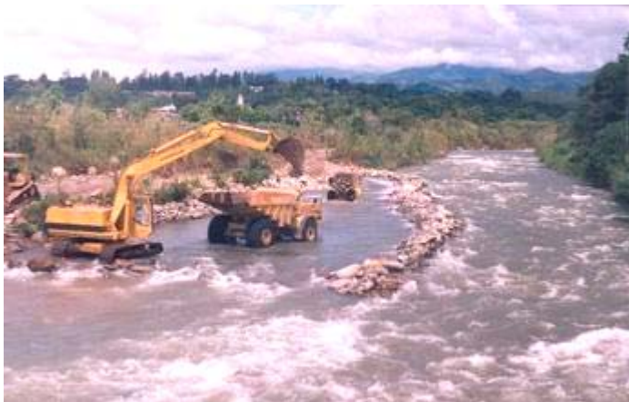
Fotografía 1.4-2. Extracción de materiales en el río General Foto del Sr. Marcos Carazo Sánchez.
