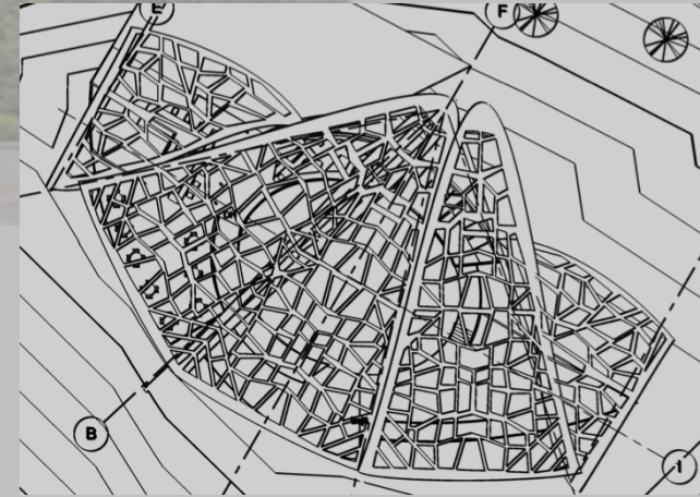
Planta de estructura de cubiertas final
