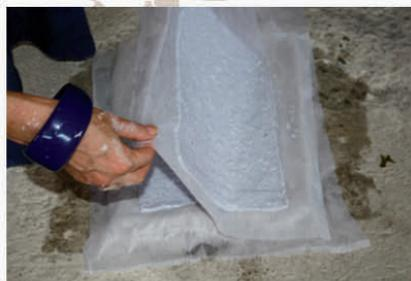
Apile los pliegos uno sobre otro. Cuando apile 5 láminas, colóquelas sobre una tabla cubierta con el paño o la cobija para que escurran y entrape la humedad.
