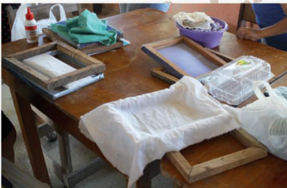
El cedazo tiene 5 centímetros de más a cada lado para fijarlo con las grapas a los lados del marco.
