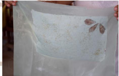
Ya secos, páseles una plancha caliente para alisarlos y terminar de sacar la humedad. Guárdelos apilados con las tablas y algo pesado encima para evitar que se ondulen.
