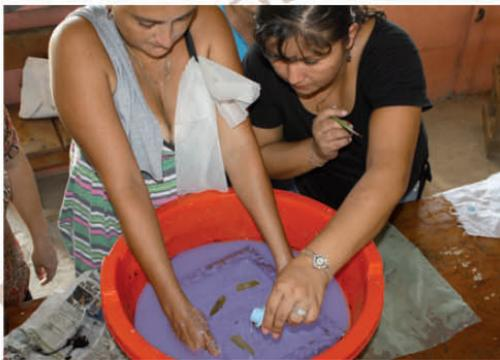
Agregue tintes o pintura al agua para obtener pliegos de colores o aplique la pintura sobre los papeles aún húmedos.
