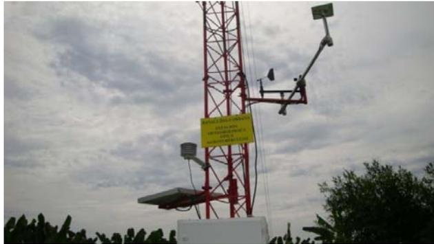
Es una estación automática Campbell. Tiene obstáculos de árboles y bodega al oeste y norte y plantaciones al sur y al este. El sensor del viento está a unos 3 m sobre el suelo. Ubicada en 9,66044°N, 82,79690°W, a 15 m.s.n.m. El pluviómetro está a unos 5 m al oeste de la estación. Se intentó establecer comunicación con el “datalogger” CR10X de la estación vía IP con la intención de chequear el funcionamiento de los sensores *in situ*, pero no se logró realizar el enlace.
