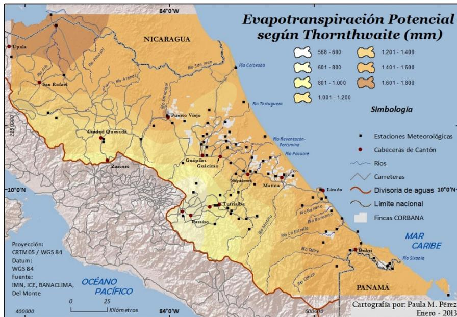
Figura 4.5 Distribución espacial de la evapotranspiración potencial utilizando el método de Thornthwaite.
