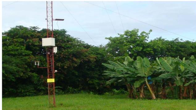
Es una estación automática marca Campbell CR10X, el pluviómetro está al oeste de la estación aproximadamente a unos 2,5 m de altura debido a problemas de inundación. El sensor del viento está a unos 3 m de altura. Tiene pasto alto de aproximadamente 30 cm y plantaciones al este y sur e instalaciones al oeste y norte, pero en general está bien ubicada. Su posición es 9,52089°N, 82,62640°W, a 12 m.s.n.m.
