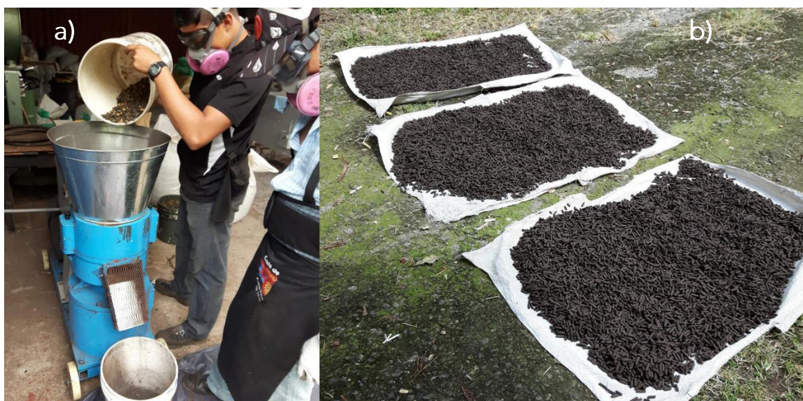
Figura 3.3. Proceso de densificación de pulpa de café (broza). a) pelletizadora ZLSP-300, b) pellets de pulpa de café secando el exceso de humedad posterior al proceso de densificación.
