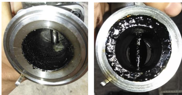
Figura 4.1. Ejemplo de condensación de alquitranes corriente abajo del sistema de gasificación de biomasa. Ensuciamiento típico del gobernador al operar con chips de madera (izquierda) y pellets de broza (derecha).
