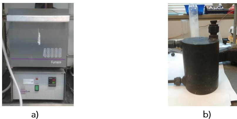
Figura 4.8. a) Horno para secado y calcinación del catalizador y b) reactor fluidizado para la reducción parcial del hierro por medio de H 2 .
