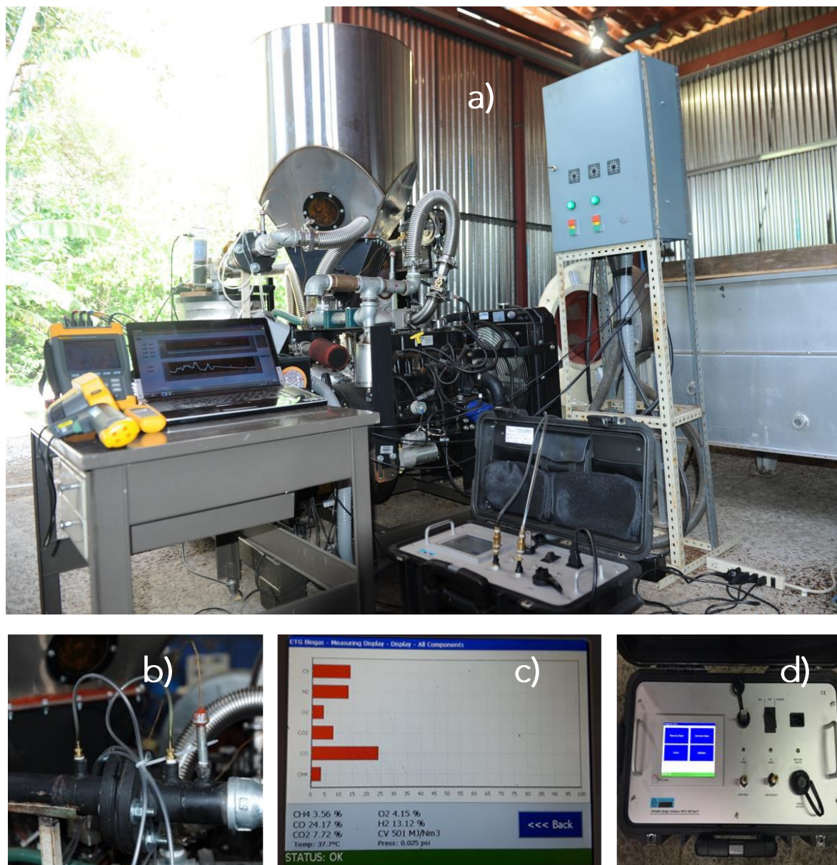
Figura 3.4. Sistema de reacción para corridas de verificación. a) Sistema con reactor de lecho descendente e instrumentación. b) medidor de orificio c) y d) analizador en línea de gas de síntesis.
