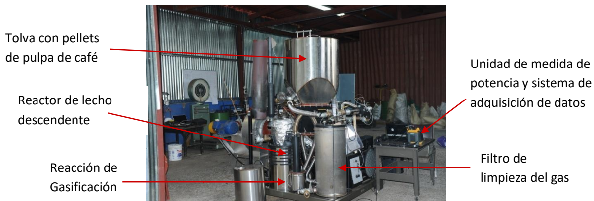
Figura 3.1. Vista de la unidad ICAFE-UCR de flujo descendente de 20 kg/h y equipos auxiliares en operación en el ICAFE (Instituto del Café) Costa Rica.
