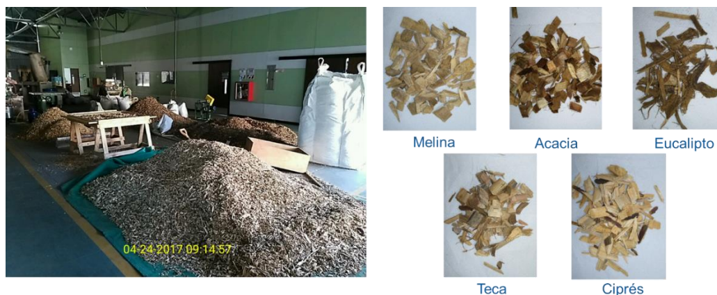
Figura 4.5. a) Tamizado de biomasa y b) tipos de maderas gasificadas en el reactor Power Pallet PP20.
