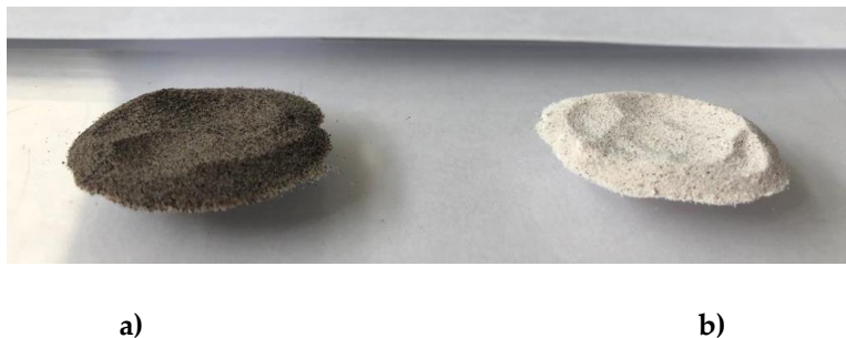
Figura 4.14. Deposición de coque después de 30 segundos de tiempo de reacción, a 500° C en el simulador CREC Riser: (a) \gamma -Al 2 O 3 (b) 10% CaO- \gamma -Al 2 O 3 . Nota: Compuesto modelo: 2M4MP, S / B = 1.0.
