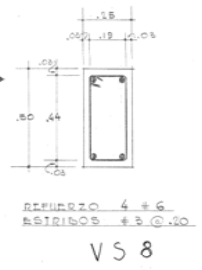
DET. VIGA de AMARRE de PILONES esc. 1/10
